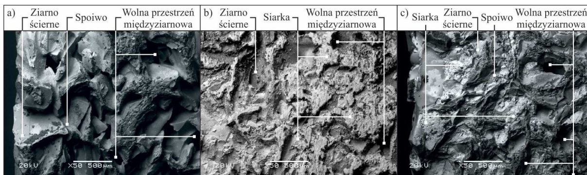
Rys. 5.2 Obrazy mikroskopowe SEM CPS z ziarnami mikrokrystalicznego korundu spiekane go o rozmiarze 46: a) przed nasiarczaniem; po nasiarczaniu bez odwirowania b) i z odwirowaniem c), z zaznaczonymi obszarami, na których widoczna jest siarka
