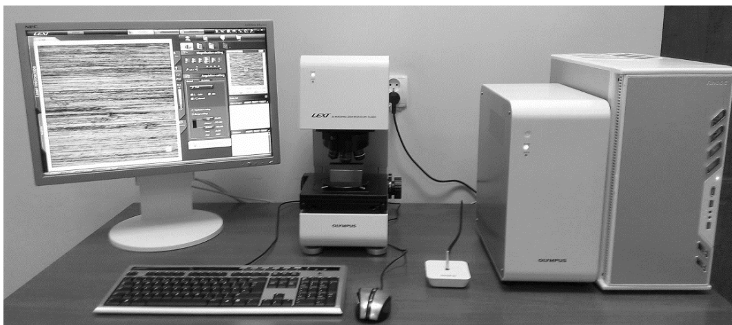
Rys. 4.3 Konfokalny laserowy mikroskop skaningowy LEXT OLS4000 firmy Olympus [113]
