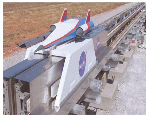
Rys. 1.2. Prototypy toru elektrycznego do przyspieszania pojazdów kosmicznych [Pis_10]
