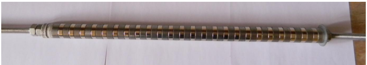
Rys. 8.4. Biegnik silnika liniowego
