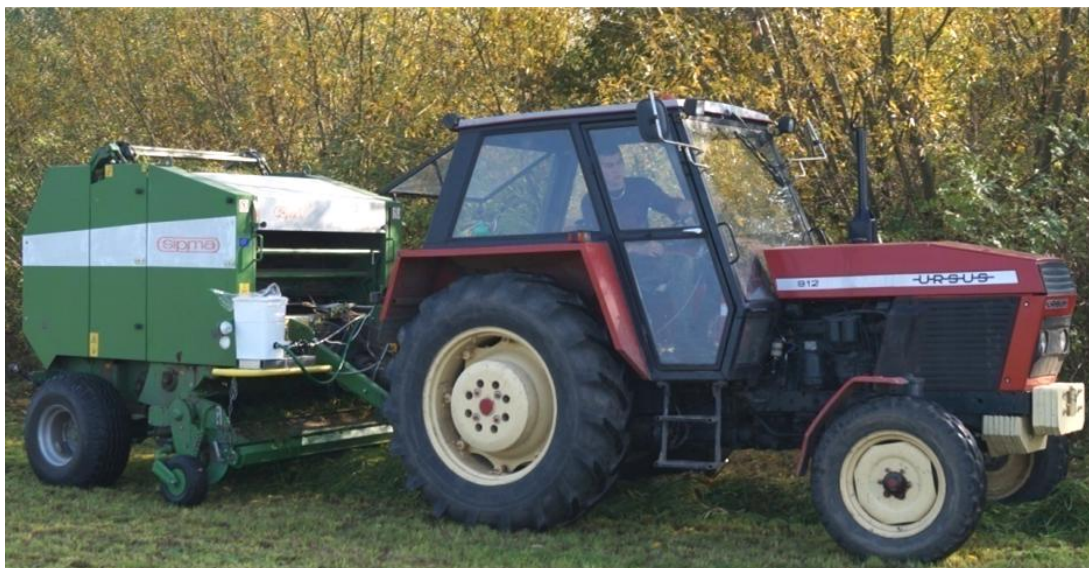
Rysunek 30. Widok agregatu ciągnik – prasa zwijająca Sipma Power Cut Z-590/1 z nabudowanym aplikatorem w czasie zbioru zielonek.
