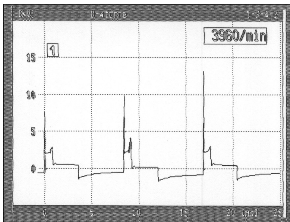
Rys.8.17. Napięcie wtórne z cewką modyfikowaną
