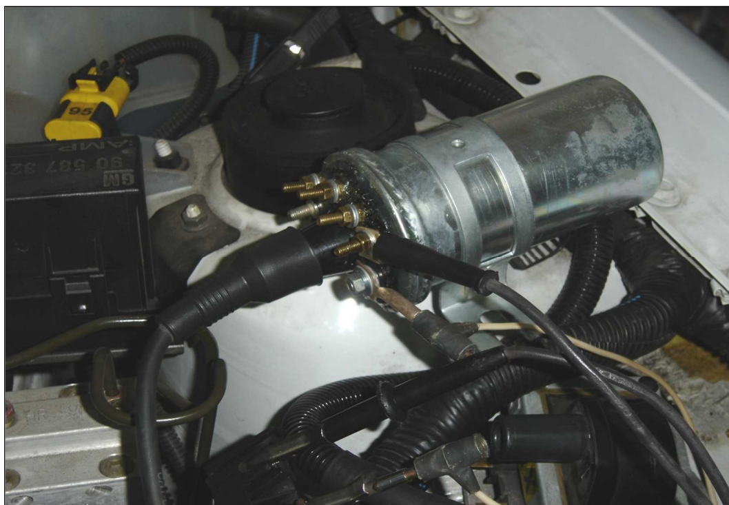
Rys.8.2. Cewka zapłonowa z regulowaną indukcyjnością w samochodzie Astra Clasic
