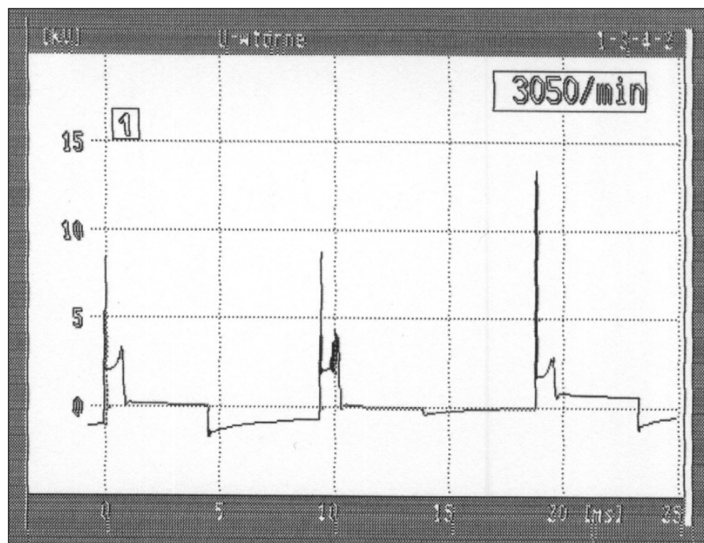
Rys.8.13. Napięcie wtórne obwodu z cewką modyfikowaną
