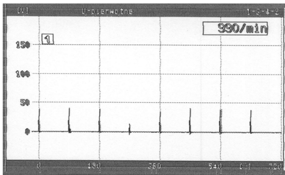
Rys.8.3. Napięcie pierwotne obwodu z cewką zapłonową modyfikowaną
