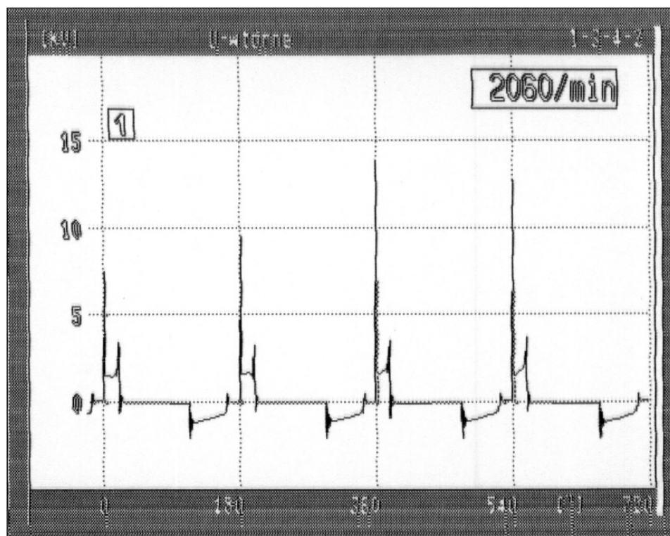
Rys.8.10. Napięcie wtórne zapłonu elektronicznego
