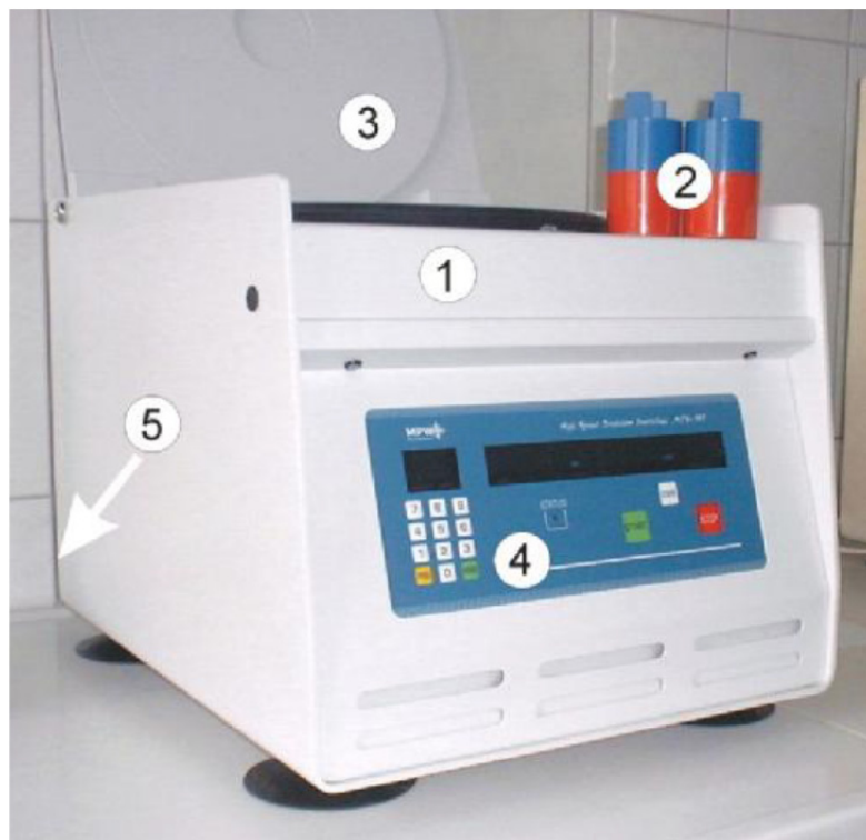
Rys. 3.10. Wirówka laboratoryjna typu MPW-350: 1 – obudowa, 2 – pojemnik na próbki, 3 – pokrywa wirówki, 4 – pulpit sterujący, 5 – włącznik
