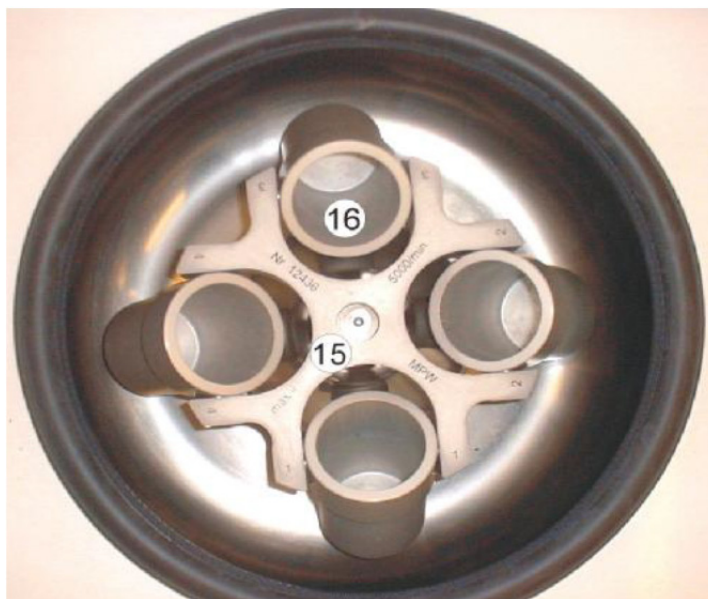
Rys. 3.12. Widok wirnika: 15 – wirnik, 16 – pojemniki na naczynia z próbkami
