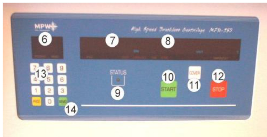
Rys. 3.11. Pulpit sterujący wirówki MPW-350: 6 – wyświetlacz numeru programu, 7 – pole wyświetlacza pokazującego prędkość wirowania, 8 – pole wyświetlacza pokazujące czas wirowania, 9 – sygnalizacja stanu wirnika, 10 – klawisz funkcyjny „START”, 11 – klawisz funkcyjny „COVER”, 12 – klawisz funkcyjny „STOP”, 13 – klawiatura numeryczna, 14 – klawisz funkcyjny „MEMO”
