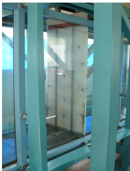
Fotografia 6.2. Wywoływacz falowy typu tłokowego
