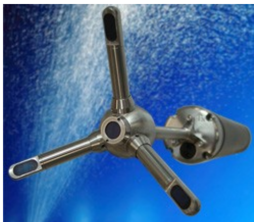
Fotografia 6.5. Przepływomierz ultradźwiękowy ( http://www.nortekusa.com/en/products/velocimeters/vector – 12.12.2012)
