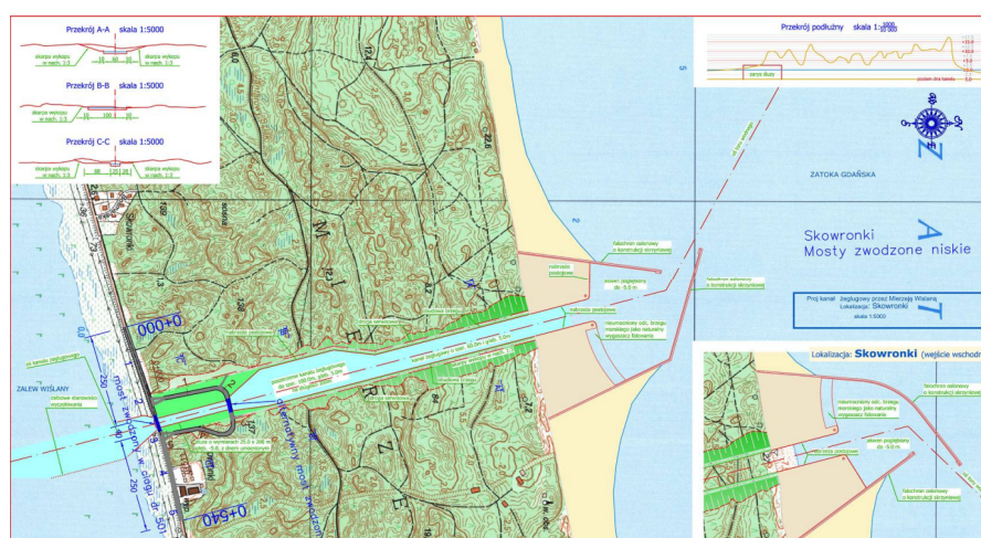
Rysunek 8.25. Warianty budowy falochronów osłaniających wejście do kanału żeglugowego ( Studium Wykonalności ... 2007/2008 )
