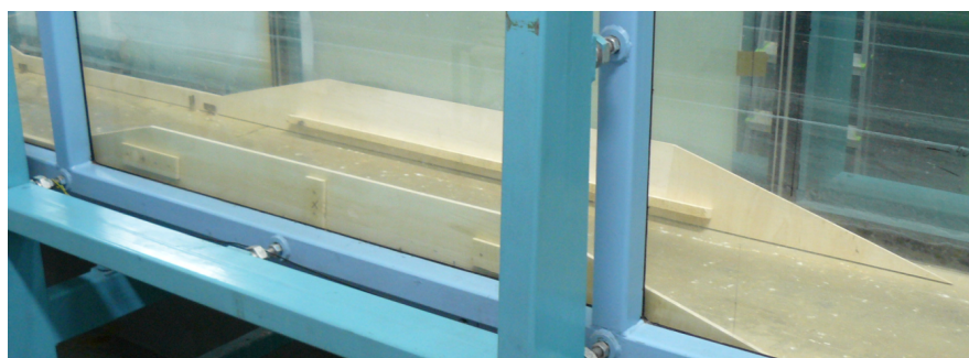
Fotografia 6.8. Wzornik modelu kształtu toru podejściowego — IBW PAN 2010
