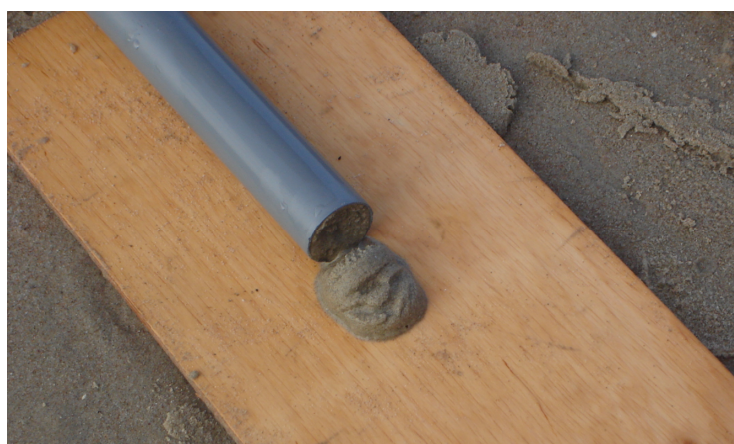
Fotografia 8.2. Próbkę osadu powierzchniowego pobrana przy użyciu rury wykonanej z PVC
