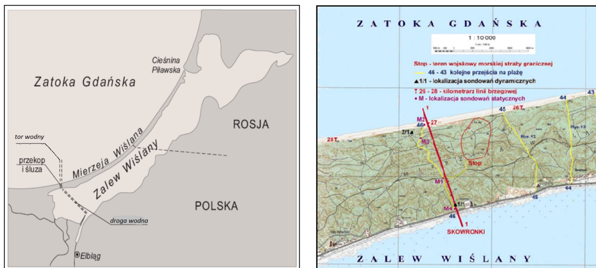
Rysunek 8.18. Lokalizacja projektowanego przekopu i toru wodnego (Studium wykonalności inwestycji 2007/2008)
