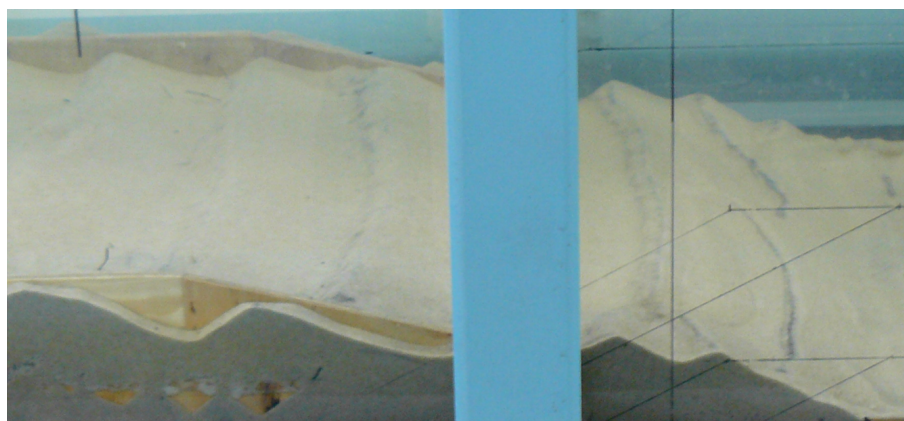
Fotografia 6.10. Przykładowe zmarszczki denne, test T1 — IBW PAN 2010
