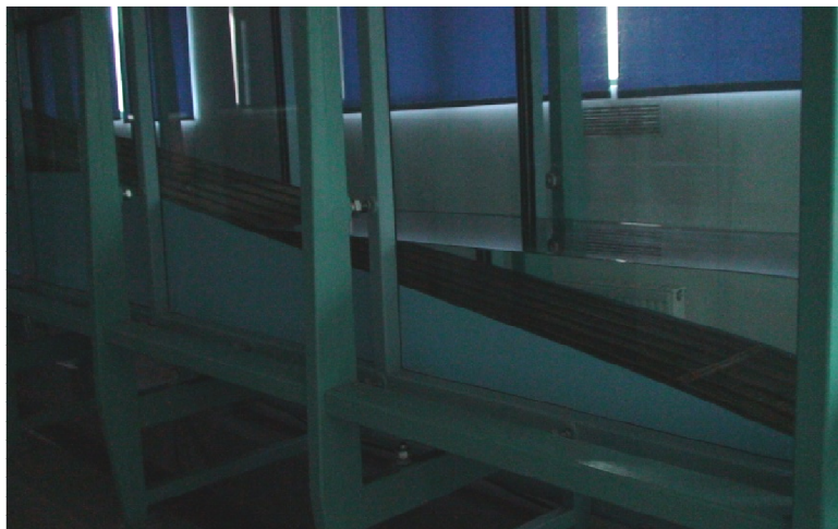
Fotografia 6.3. Pochłaniacz energii falowania (Ł. Sobczak)
