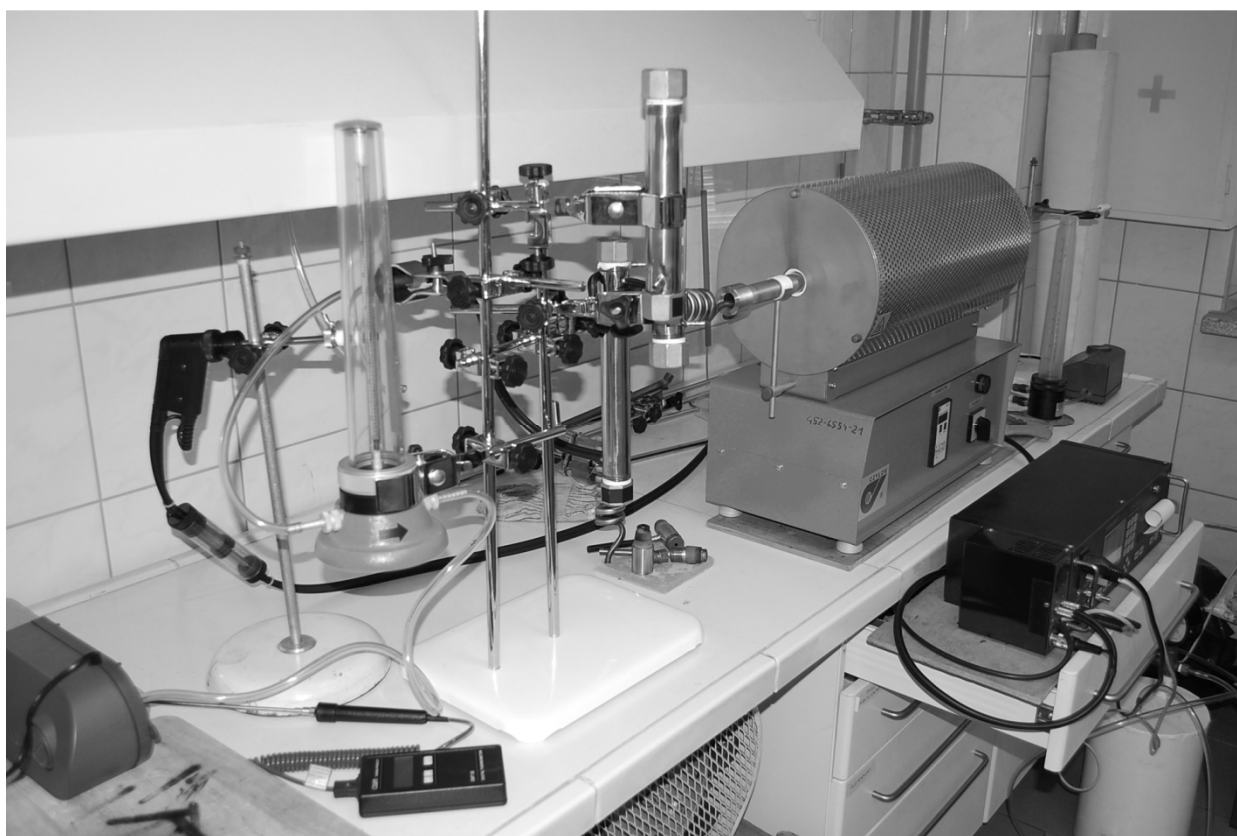
Zdjęcie. 3.6. Instalacja do badania procesu adsorpcyjnego oczyszczanie spalin
