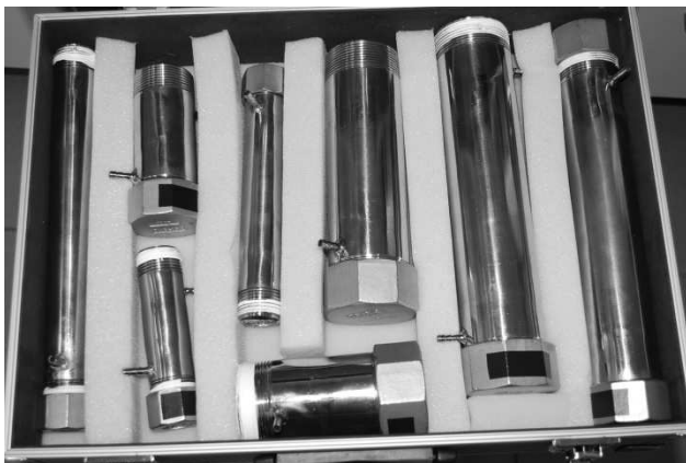
Zdjęcie. 3.4. Instalacja do badania procesu odsiarczanie spalin metodą wapniową; obok zestaw skruberów
