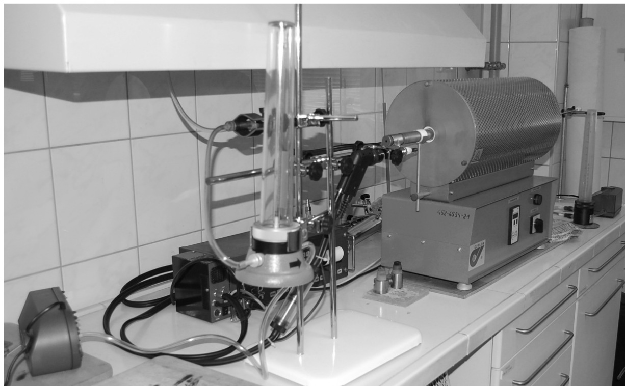
Zdjęcie 3.1. Instalacja do badania procesu spalania i współspalania odpadów
