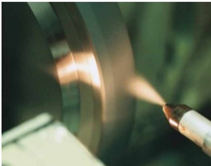
Rys. 25. Widok ogólny strefy szlifowania w procesie realizowanym z doprowadzeniem PCS metodą MQL [KLO98a]
