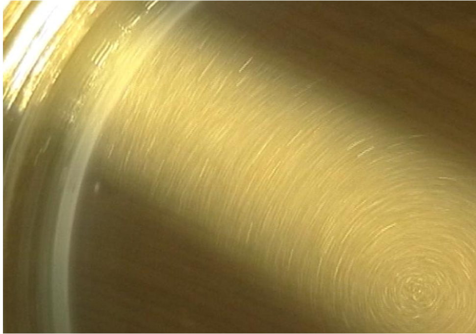
Rys.3.04 Prześwietlanie arkuszem światła - linie prądu przepływu w obszarze warstwy granicznej [Jakubowski 2004]
