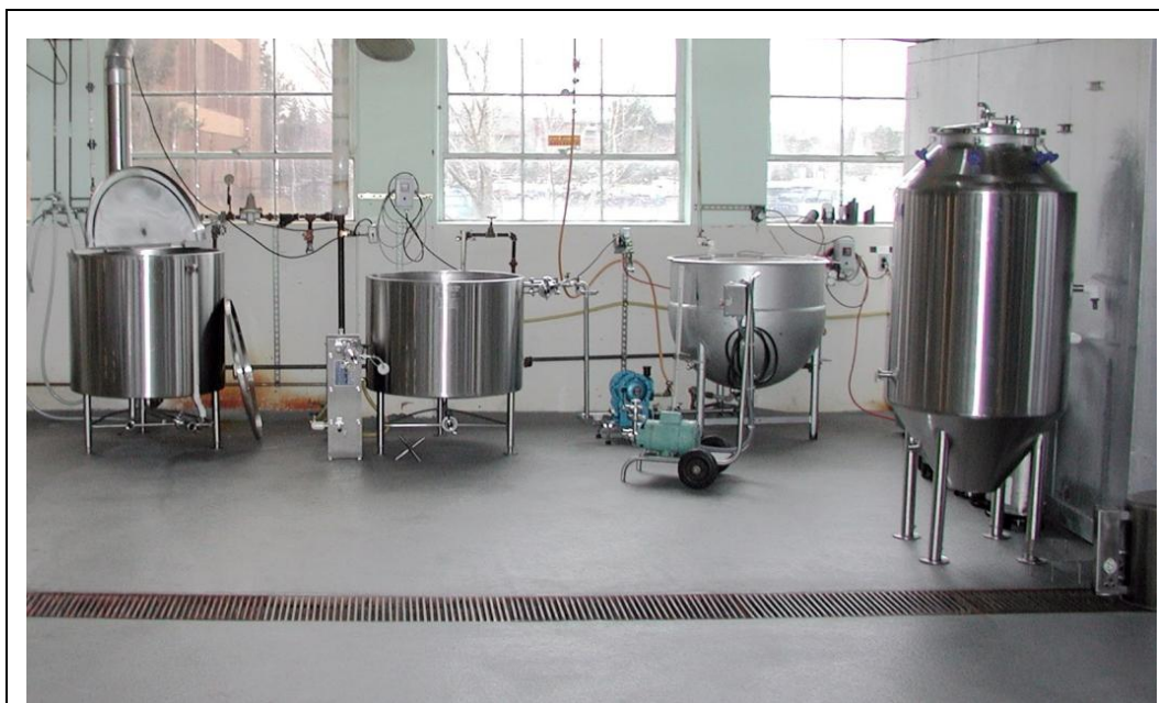
Rys.2.05 Zbiornik whirlpoola (drugie naczynie od lewej) w linii laboratoryjnej warzelni (pojemność whirlpoola 1 hl)
