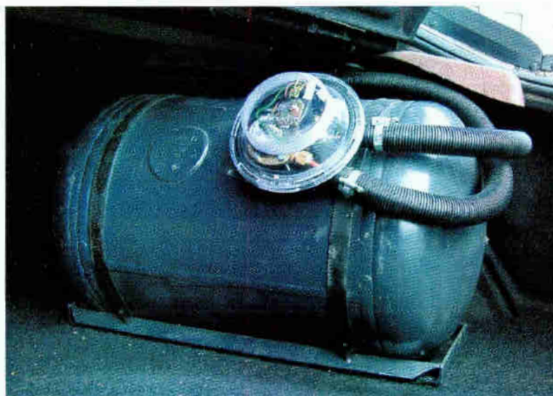
Rys. 2.3. Zbiornik typu walcowego zamontowany w bagażniku samochodu osobowego
