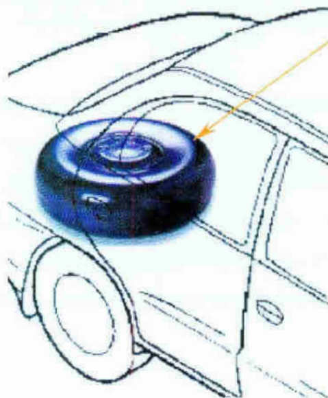
Rys. 2.4. Montaż zbiornika toroidalnego we wnęce na koło zapasowe [83]
