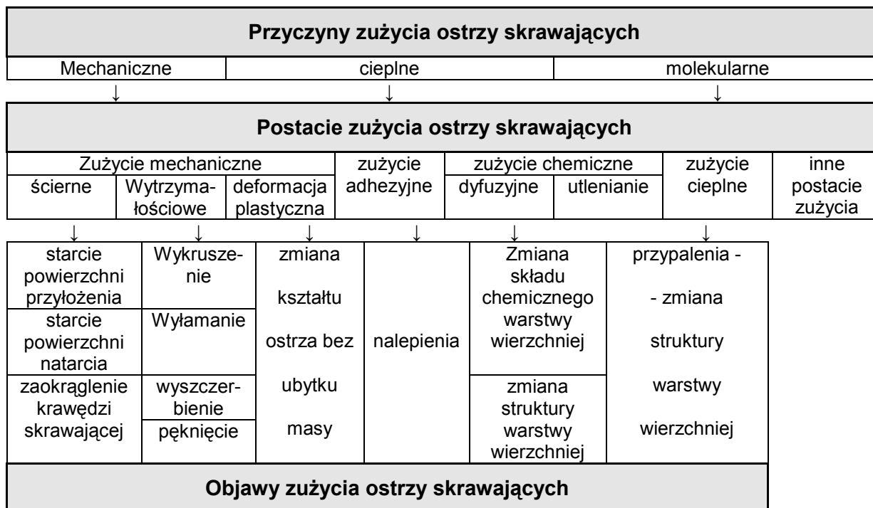
Rys. 3.27. Przyczyny, postacie i objawy zużycia ostrzy skrawających [Kupc97]
