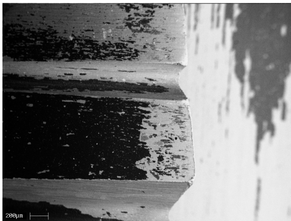
i) ostrze 3, zwój 1 i 2 nr DV pokryty warstwą TiC ( \alpha = 0\% ), po 300 nagwintowanych nakrętkach
