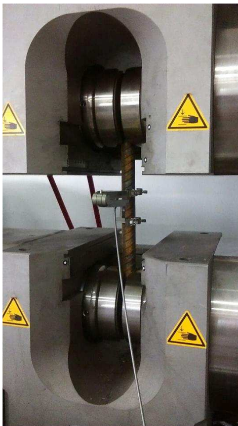
Rys. 6.12. Stanowisko do badań granicy plastyczności, modułu sprężystości i wytrzymałości na rozciąganie prętów zbrojeniowych
