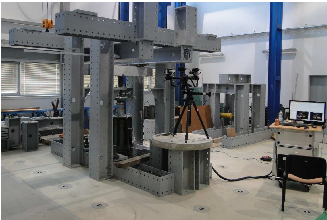
Rys.6.5. Ogólny Widok stanowiska do badań belek od strony powierzchni mierzonej systemem Aramis 4M
