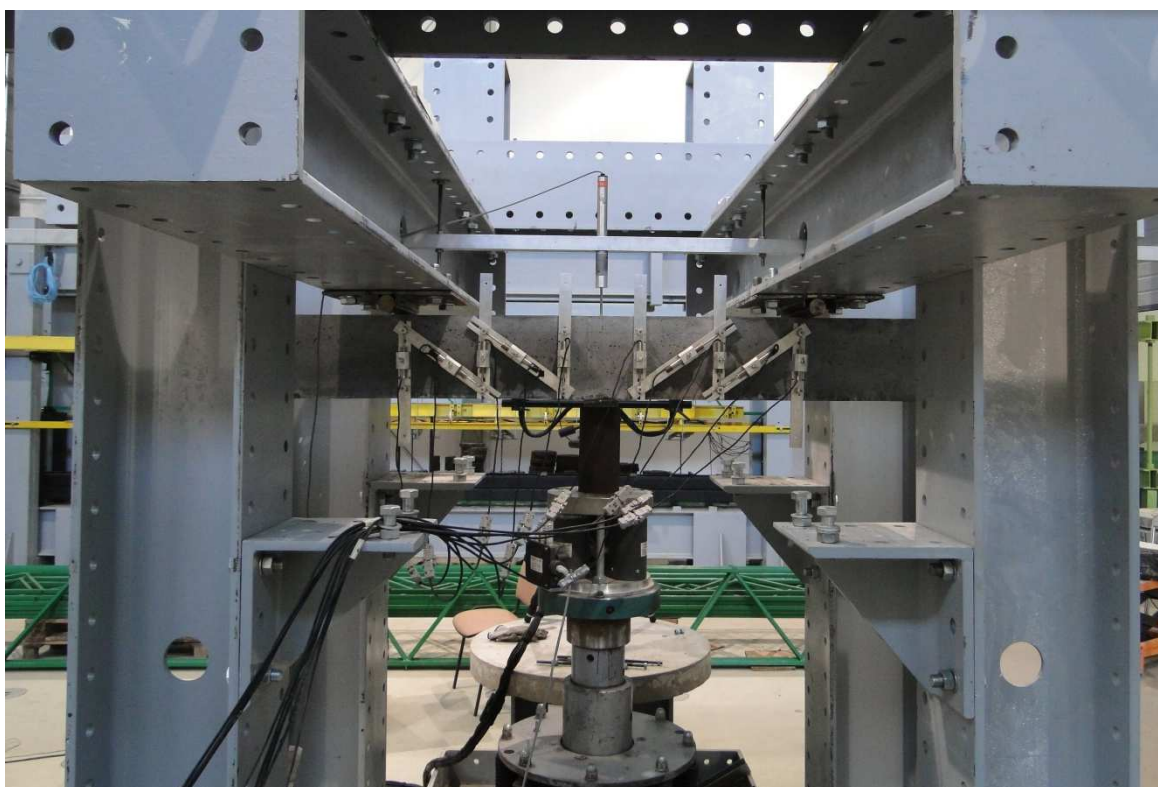
Rys.6.4. Widok stanowiska do badań belek od strony powierzchni mierzonej systemem SAD256
