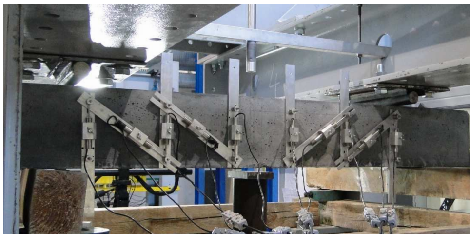
Rys. 6.3. Ogólny widok czujników Systemu SAD 256 do pomiaru ugięcia i odkształceń powierzchni bocznej elementu [83], [127]
