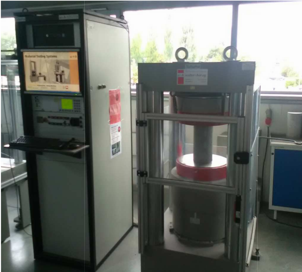
Rys. 6.8. Ogólny widok stanowiska do badania wytrzymałości na ściskanie użytego fibrokompozytu
