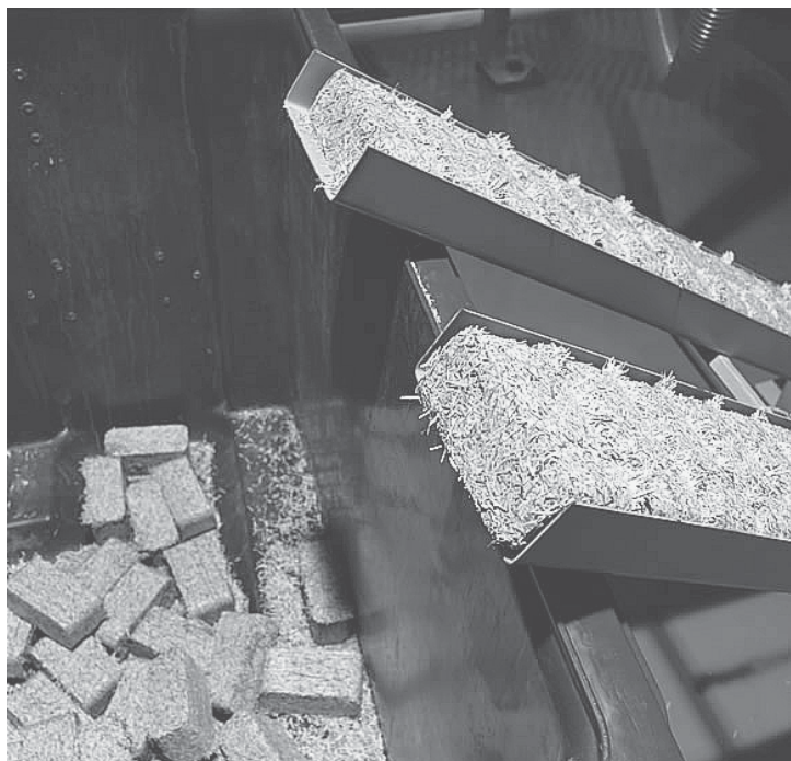
Kostka prasowana z dotychczas używanych posiekanych banknotów
