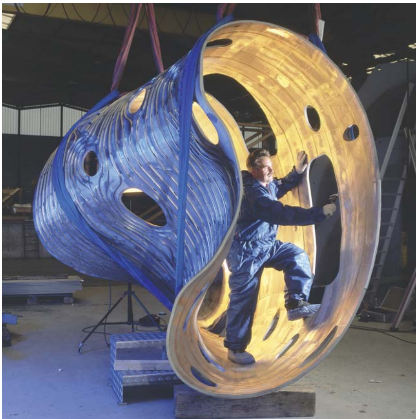
Budowa wnętrza tokamaka ASDEX
