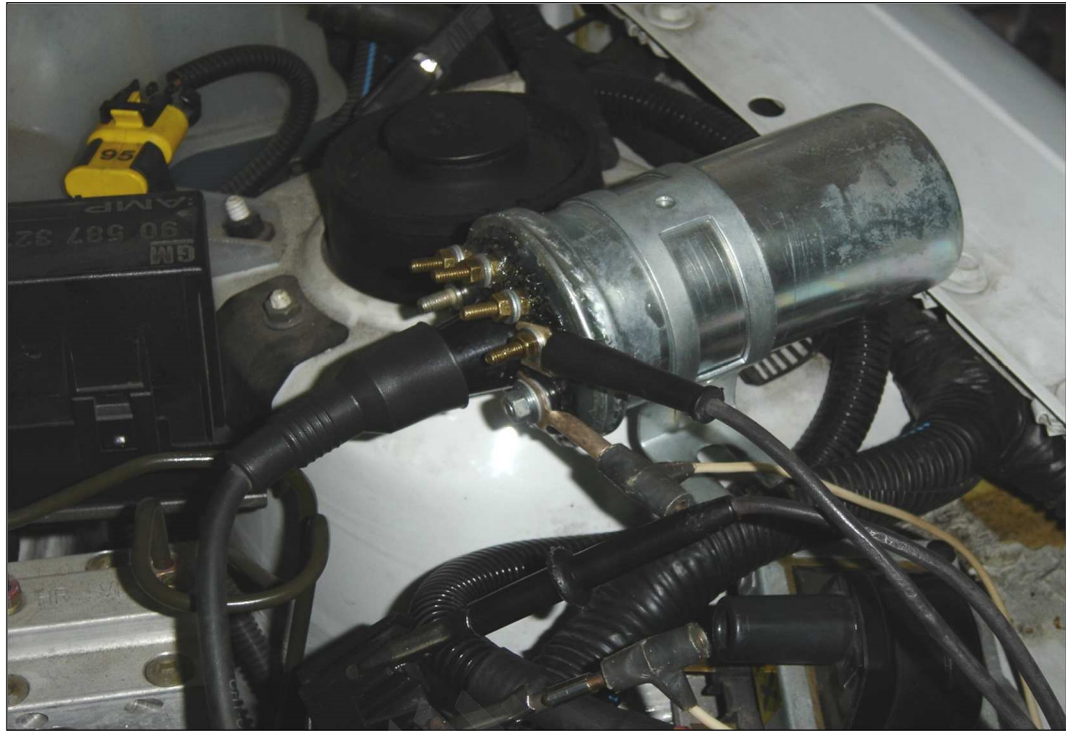
Rys.8.2. Cewka zapłonowa z regulowaną indukcyjnością w samochodzie Astra Clasic
