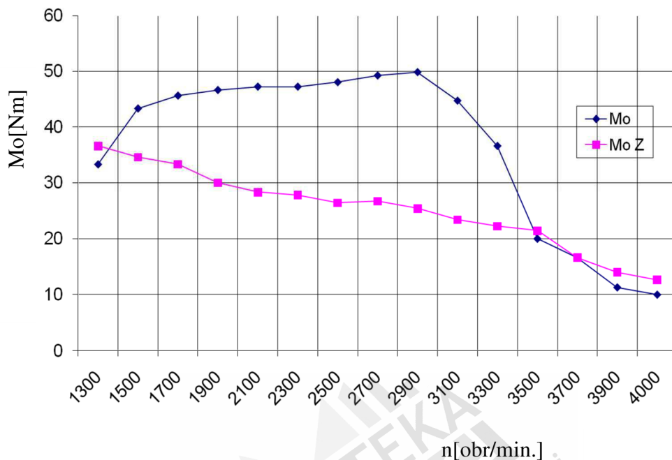
Rys.9.13. Charakterystyka przebiegu momentu obrotowego badanego silnika przy różnych wartościach odstępów elektrod świec zapłonowych.
