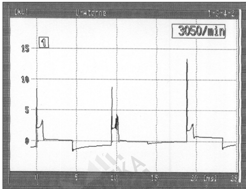
Rys.8.13. Napięcie wtórne obwodu z cewką modyfikowaną
