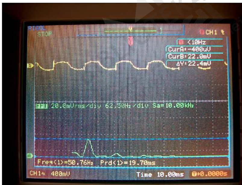
Załącznik do rysunku 5.16. Przebiegi prądów w obwodzie pierwotnym z zawartością harmoniczną dla : a) układu standardowego b) zmodyfikowanego
