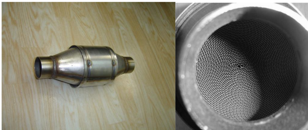
Rys. 127. Samochodowy reaktor dopalania spalin (nowy) wykonany na bazie bloku z folii stalowej [44]
