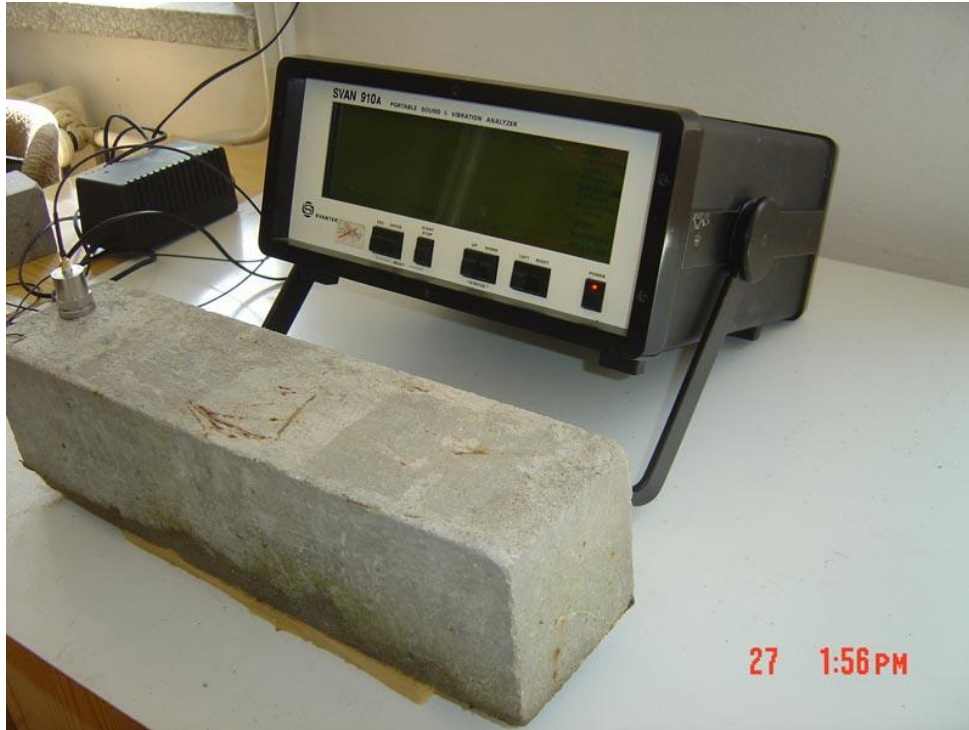
Rys. 5.7. Stanowisko do badań dynamicznego modułu odkształcenia postaciowego przy użyciu aparatu SVAN 910A
