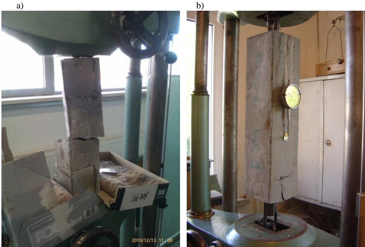
Rys. 6.14. Obraz zniszczenia próbki o wymiarach 10x10x40 cm w badaniu wytrzymałości na osiowe rozciąganie: a) zniszczenie w obszarze bazy pomiarowej, b) poza bazą pomiarową
