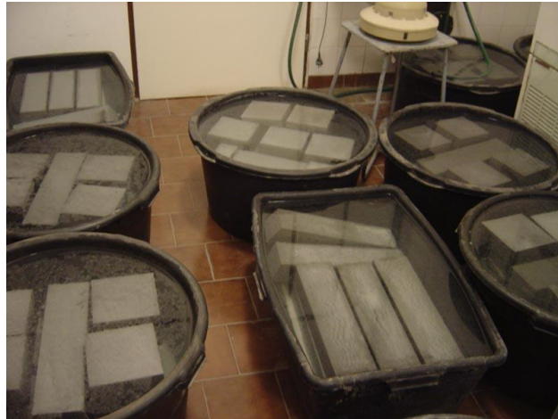
Rys. 4.4. Ogólny widok elementów próbnych fibrokompozytu w trakcie dojrzewania
