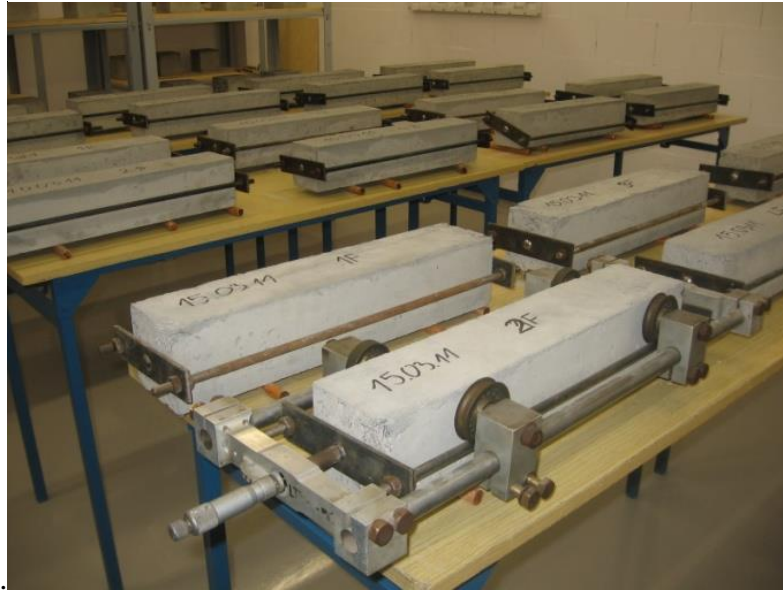
Rys. 4.6. Widok ogólny próbek przeznaczonych do badania skurczu
