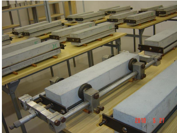
Rys. 5.2. Stanowisko do badań skurczu fibrokompozytu
