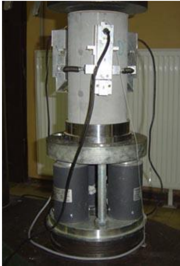
Rys. 5.4. Stanowisko do badań modułu sprężystości przy ściskaniu
