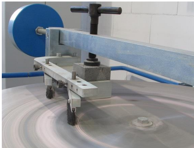
Rys. 6.32. Badanie ścieralności fibrokompozytu zawierającego 1,5% włókien stalowych na tarczy Boehme'go
