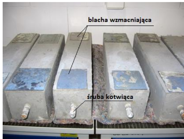
Rys. 4.5. Elementy próbne przeznaczone do badania zależności naprężenie-odkształcenie przy osiowym rozciąganiu
