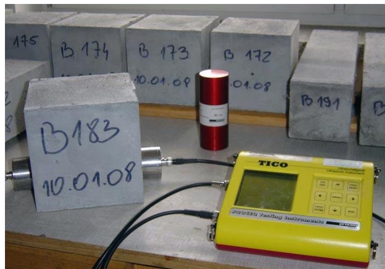
Rys. 5.3. Widok ogólny stanowiska do badań dynamicznego modułu sprężystości w fibrokompozycie przy użyciu betonoskopu typu TICO
