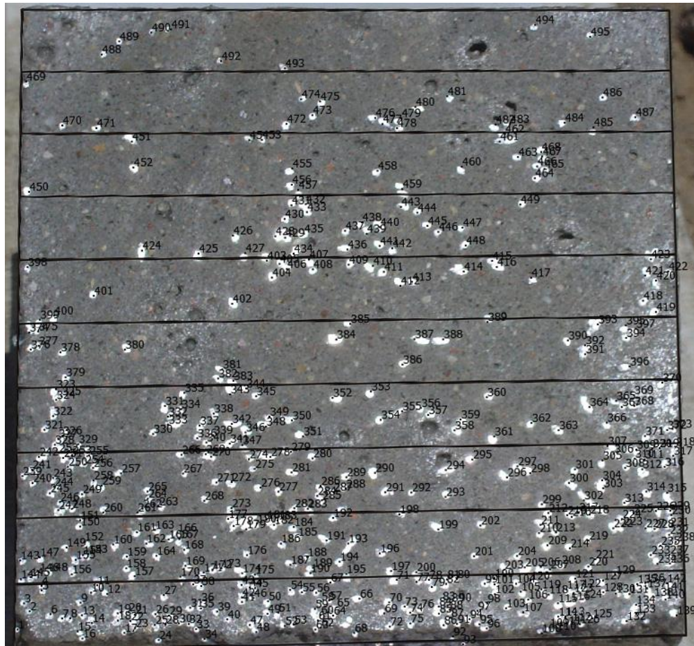
Rys. 7.9. Przekrój próbki fibrokompozytu z naniesionymi polami podziału i numeracją przekroju włókien
