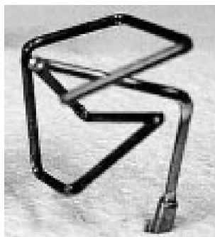
Rys. 2.12. 10-cio segmentowa genetyczna mała antena [1]
