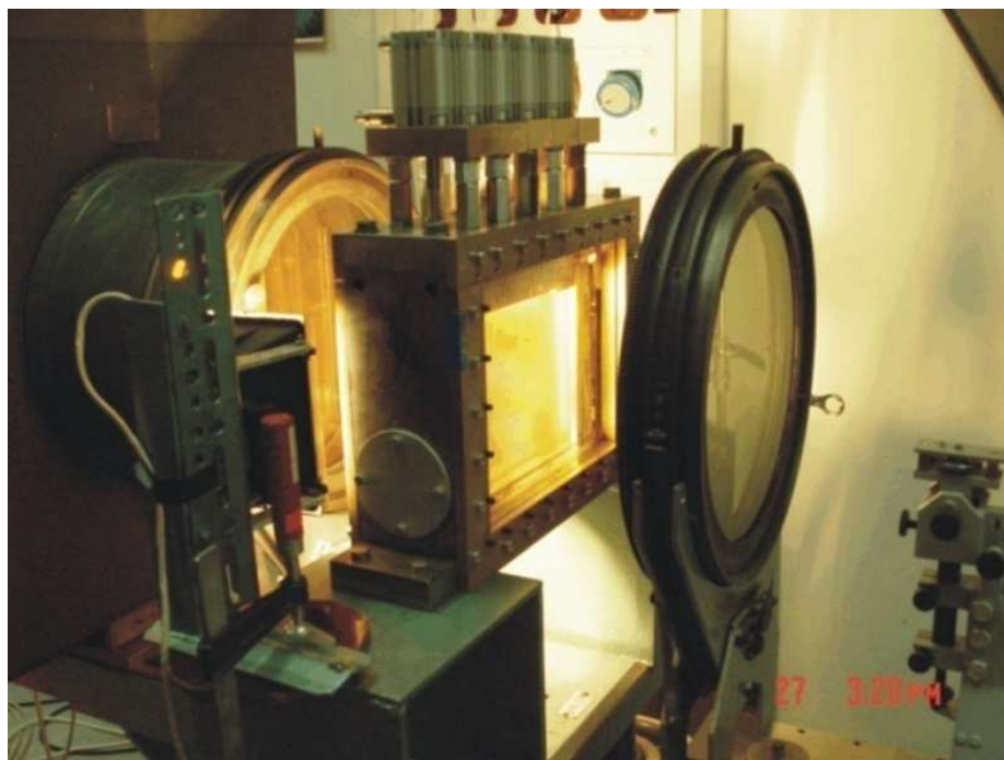
Rys.3.2. Widok obciążonego modelu umieszczonego w układzie optycznym polaryzatora.
