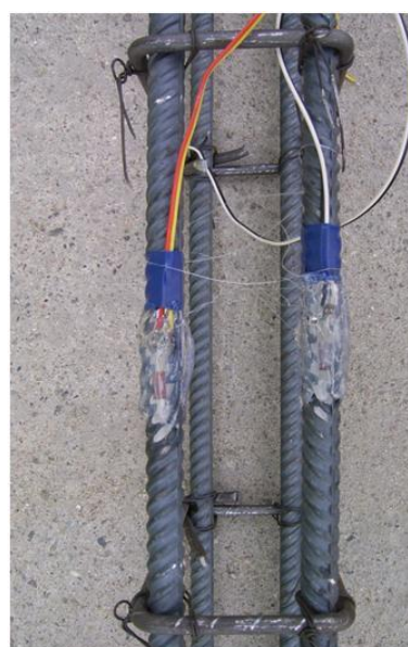
Rys. 5.5. Ogólny widok umieszczenia tensometrów elektrooporowych na: a). taśmie wzmacniającej, b). zbrojeniu głównym belek
