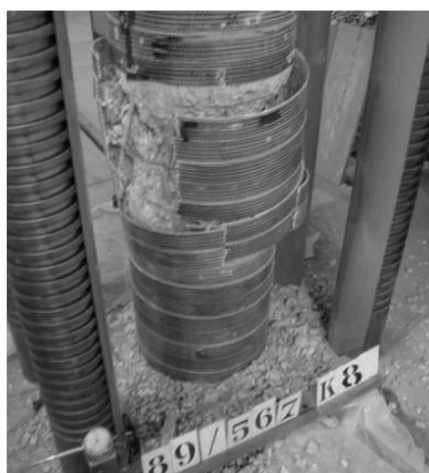
Rys. 2.15. Mechanizm zniszczenia słupa wzmocnionego taśmami CFRP oraz porównanie nośności elementów ściskanych [33]
