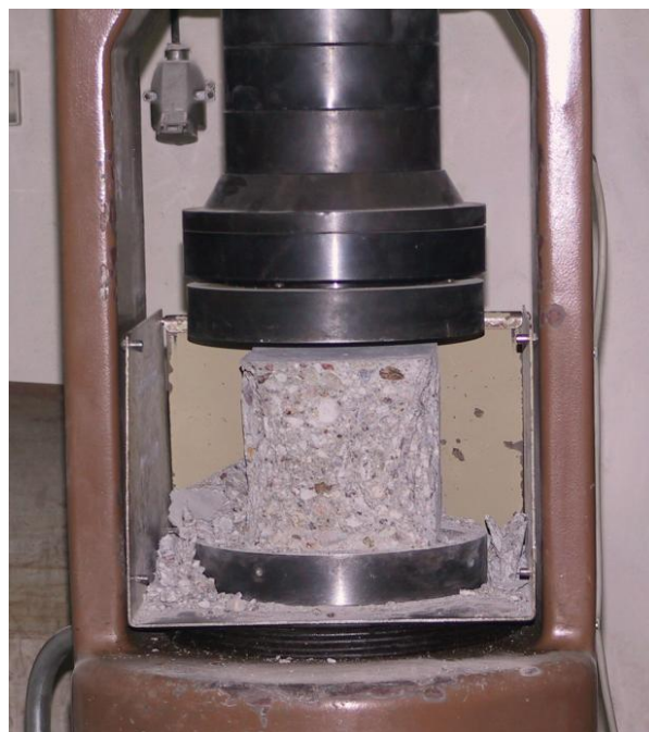
Rys. 7.1. Obraz zniszczenia próbek betonowych podczas badania wytrzymałości na ściskanie: a) próbka walcowa, b) próbka sześcienna
