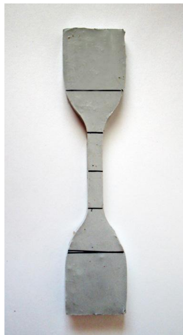
Rys. 5.7. Widok próbki do badania właściwości kleju epoksydowego w warunkach rozciągania: a) wymiary kształt próbki, b) wykonany element próbny
