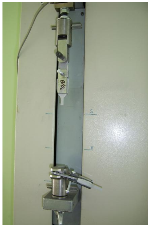
Rys. 7.3. Widok stanowiska do badania wytrzymałości na osiowe rozciąganie kleju Resin 220:
