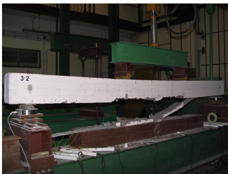
Rys. 8.6. Widok belki W-II/3 po zniszczeniu na skutek odspojenia taśmy CFRP
