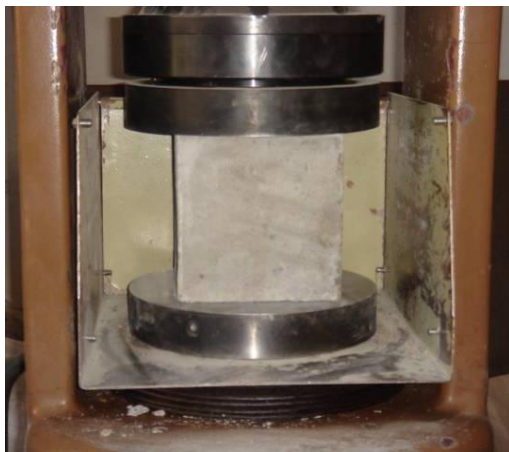
Rys. 6.7. Widok stanowiska do badania wytrzymałości na ściskanie: a) betonu, b) kleju epoksydowego
