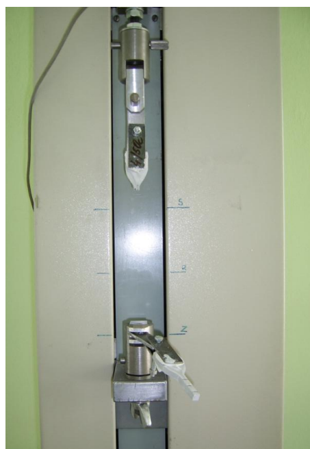
Rys. 7.6. Obraz zniszczenia próbki kleju epoksydowego podczas badania wytrzymałości na osiowe rozciąganie: a) zniszczenie w obszarze bazy pomiarowej, b) zniszczenie poza obszarem bazy pomiarowej
