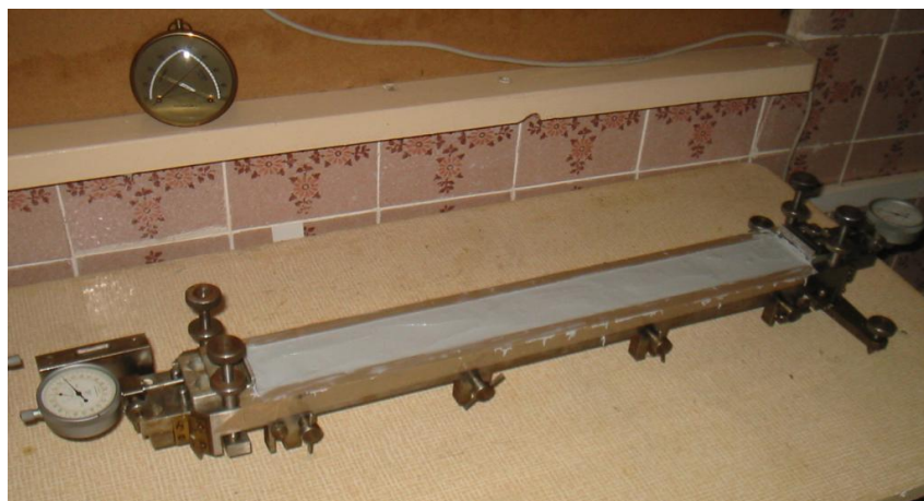
Rys. 6.8. Widok stanowiska do badania skurczu utwardzania kleju epoksydowego
