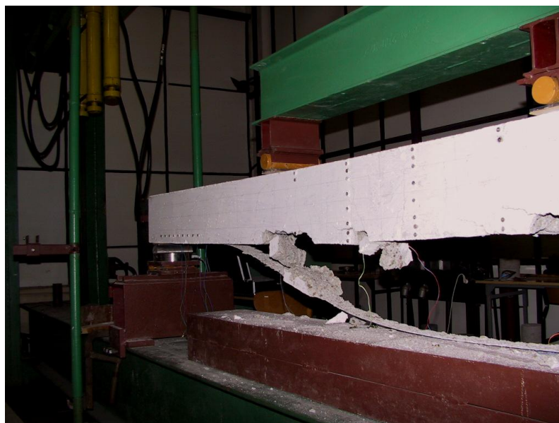
Rys. 8.5. Widok belki W-I/1 po zniszczeniu na skutek odspojenia taśmy CFRP
