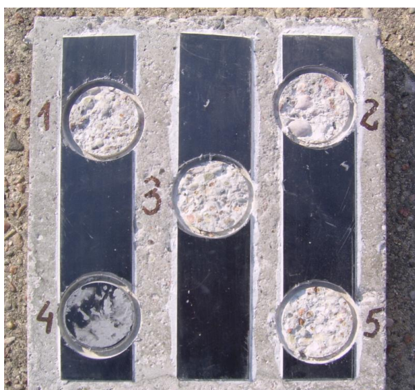
Rys. 7.10. Obraz zniszczenia próbek po badaniu wpływu starzenia przyspieszonego na przyczepność normalną kleju epoksydowego do betonu
