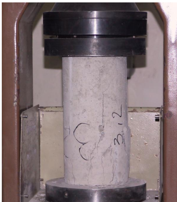
Rys. 7.1. Obraz zniszczenia próbek betonowych podczas badania wytrzymałości na ściskanie: a) próbka walcowa, b) próbka sześcienna
