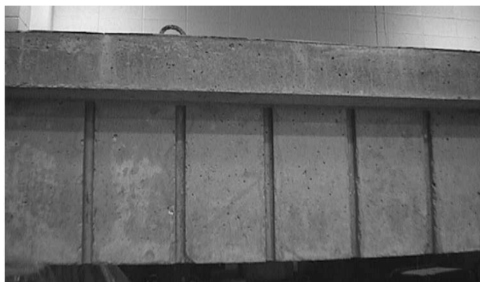
Rys. 2.16. Belka z pionowymi bruzdami przygotowana do wzmocnienia z uwagi na ścinanie poprzez wklejenie prętów FRP [101]
