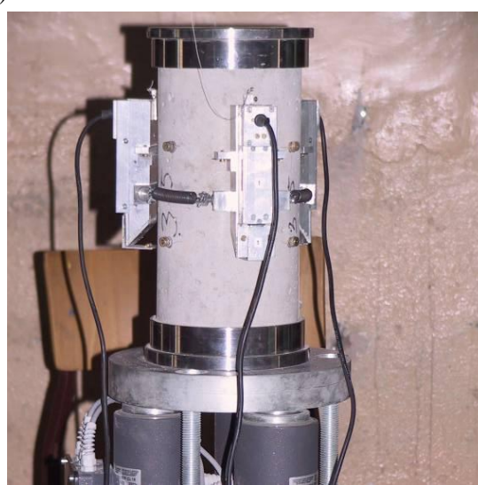
Rys. 6.9. Widok stanowiska do badania: a) wytrzymałości betonu na rozciąganie przez rozłupywanie, b) modułu sprężystości betonu przy ściskaniu
