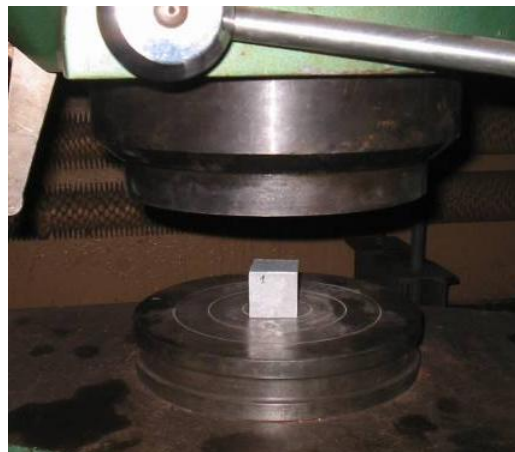
Rys. 6.7. Widok stanowiska do badania wytrzymałości na ściskanie: a) betonu, b) kleju epoksydowego
