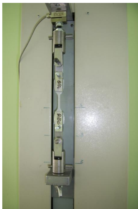
Rys. 7.3. Widok stanowiska do badania wytrzymałości na osiowe rozciąganie kleju Resin 220:
