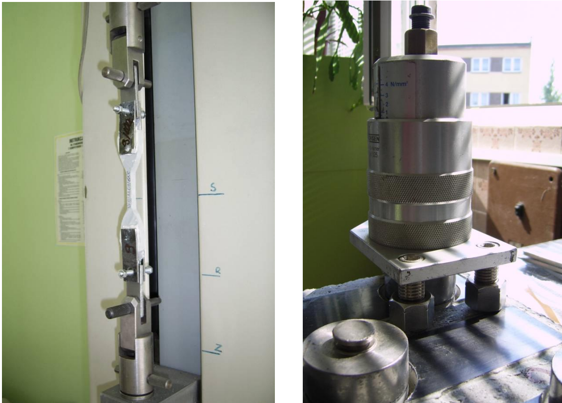
Rys. 6.10. Widok stanowiska do badania: a) wytrzymałości, odkształcenia i modułu sprężystości przy osiowym rozciąganiu kleju epoksydowego, b) przyczepności normalnej kleju epoksydowego do betonu w warunkach odrywania
