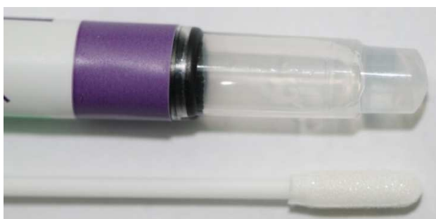
Rys. 7.9. Wymazówka i zbiorniczek z odczynnikami w wymazówkach Pro-TECT
