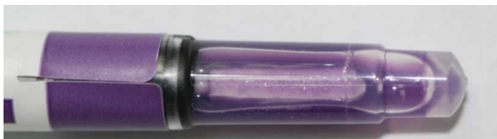
Rys. 7.8. Wymarówka zabarwiona w wyniku dużej ilości białka na powierzchni poddanej ocenie
