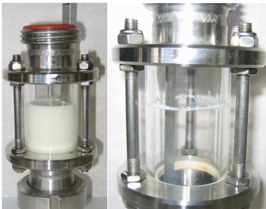
Rys. 7.6. Element kontrolny podczas brudzenia i po standardowym zabrudzeniu początkowym
