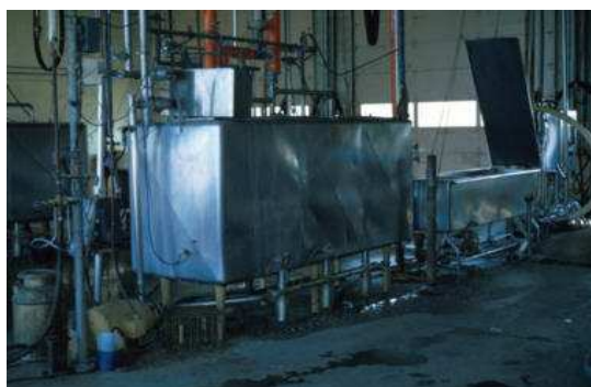
Rys. 1.1. Pierwsze centralne stacje mycia w systemie CIP: a) stacja jednozbiornikowa; b) stacja dwuzbiornikowa
