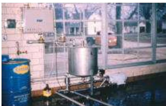
Rys. 1.1. Pierwsze centralne stacje mycia w systemie CIP: a) stacja jednozbiornikowa; b) stacja dwuzbiornikowa
