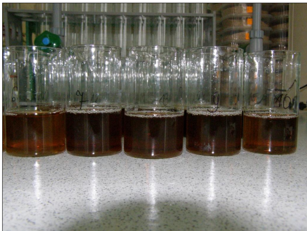
Rys. 16. Ciecz nadosadowa po 18 godzinach wytrząsania z 1 mol NaOH
