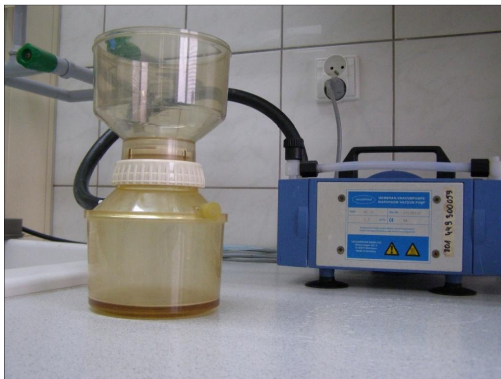
Rys. 15. Zestaw do filtracji badanych próbek z zastosowaniem pompy próżniowej
