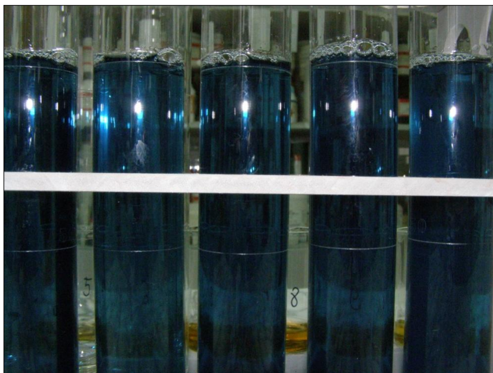
Rys. 14. Cylindry miarowe z próbkami wody, w której oznaczano stężenie ortofosforanów metodą błękitu molibdenowego
