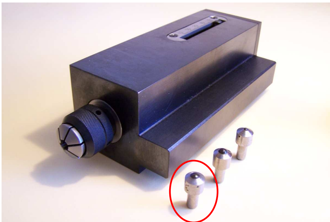
Rys. 7.5. Widok ogólny narzędzia użytego w badaniach i zastosowana końcówka diamentowa o promieniu r_d=3,5 [mm]
