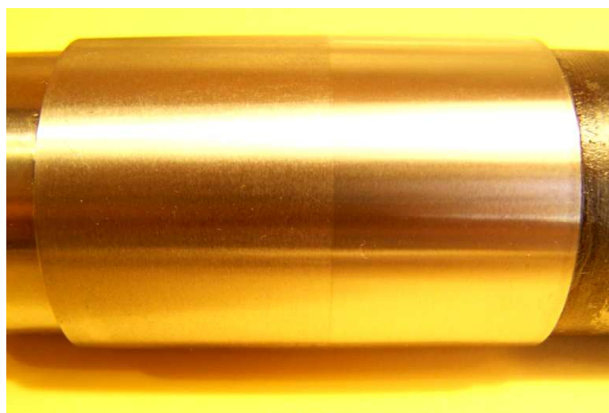
Rys. 2.19. Porównanie refleksyjności powierzchni; po prawej powierzchnia nagniatana ślizgowo, po lewej – szlifowana (pow. \sim 1\times )
