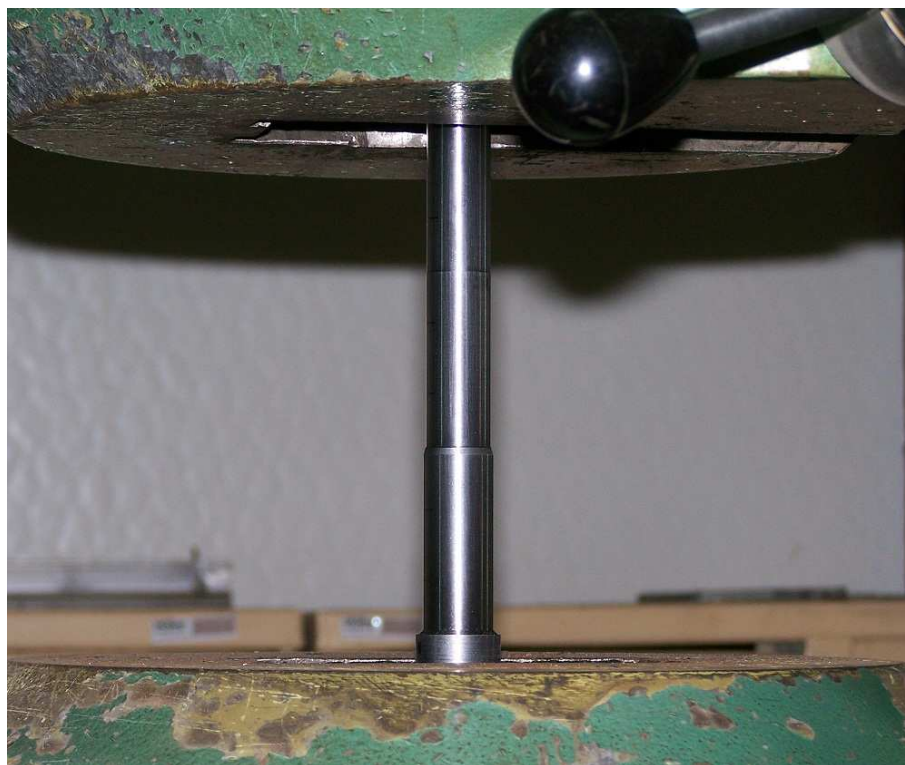
Rys. 5.10. Sposób mocowania próbki trójstopniowej w uchwytach maszyny wytrzymałościowej ZD 40
