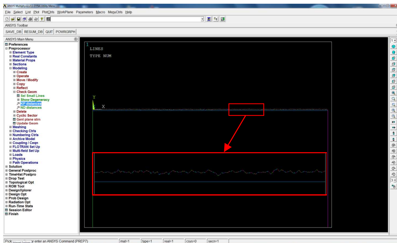
Rys. 7.16. Profil chropowatości powierzchni po obróbce nagniataniem w programie ANSYS dla F=15 [N]
