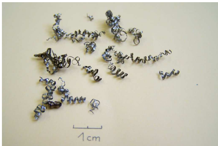
Rys. 7.46. Widok uzyskanych kształtów wiórów dla przypadku M3
