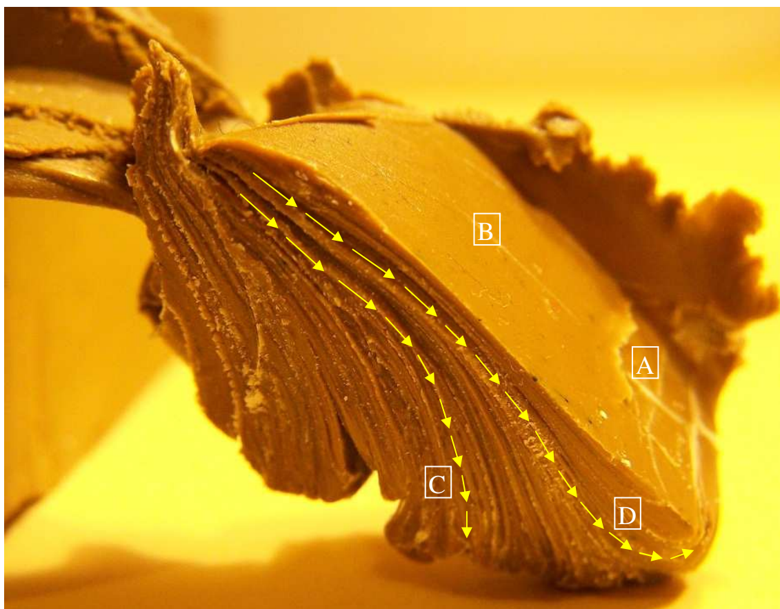
Rys. 3.17. Ukształtowany wiór po przejściu klina dla a_p=6 [mm] i \gamma=-30^\circ
