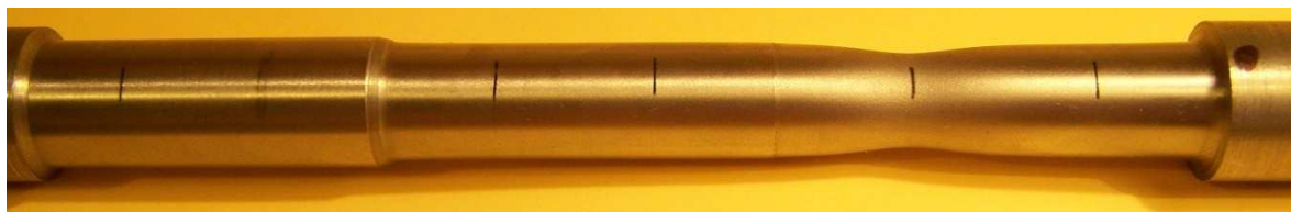
Rys. 5.13. Próbka trójstopniowa z widocznym przewężeniem
