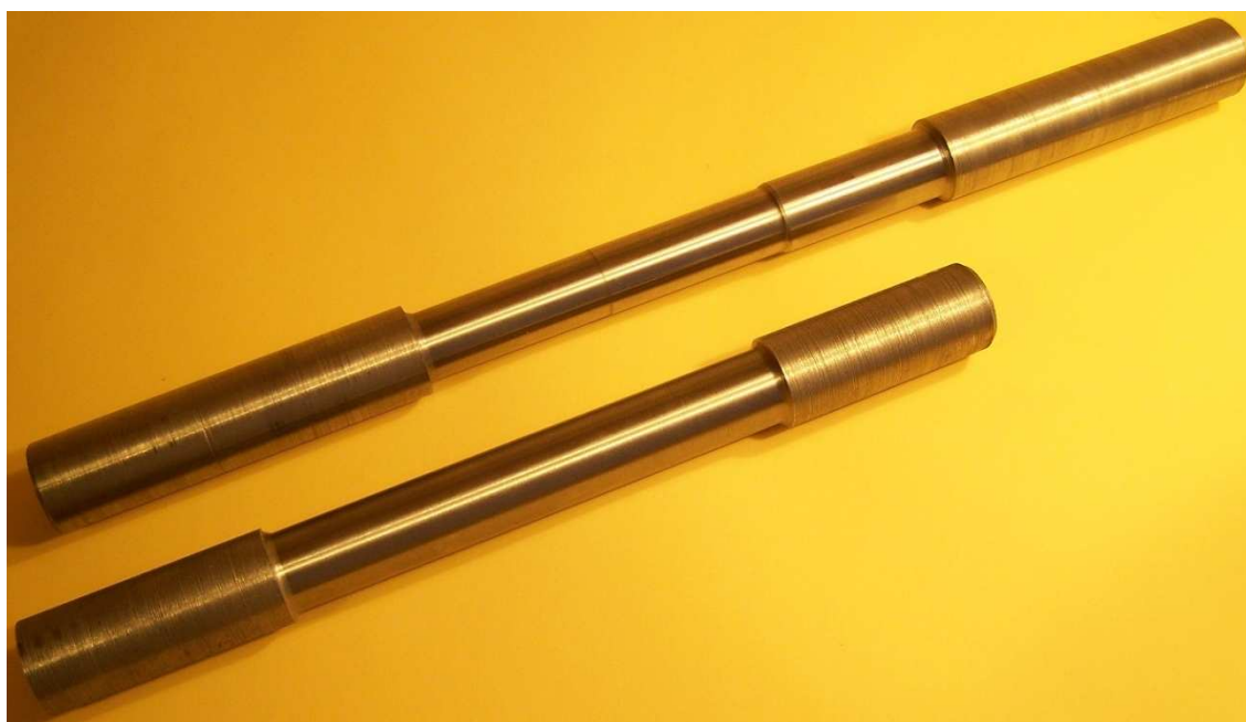
Rys. 5.8. Próbkę znormalizowaną i trójstopniową użyte w doświadczeniu
