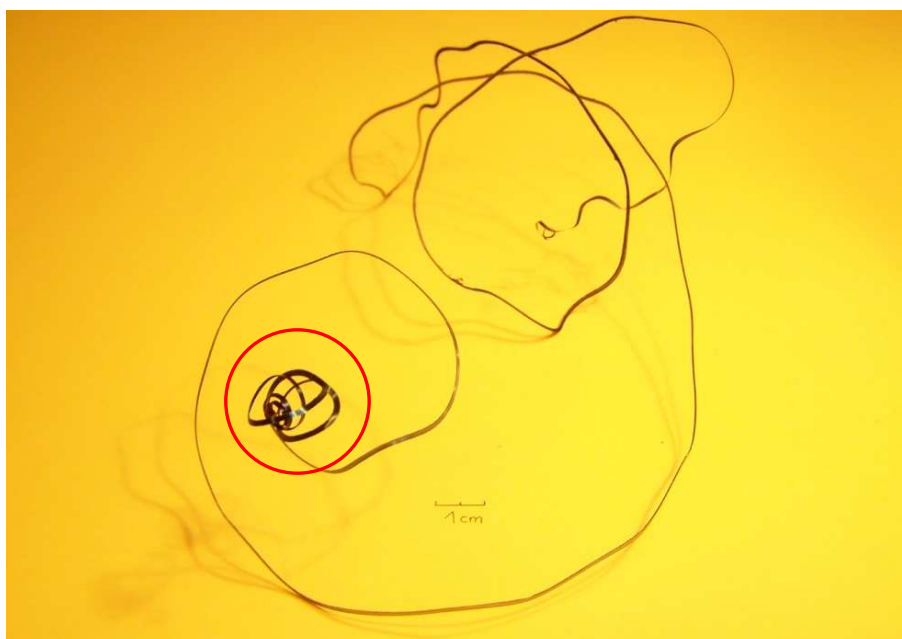
Rys. 7.32. Widok uzyskanych kształtów wiórów dla przypadku 5
