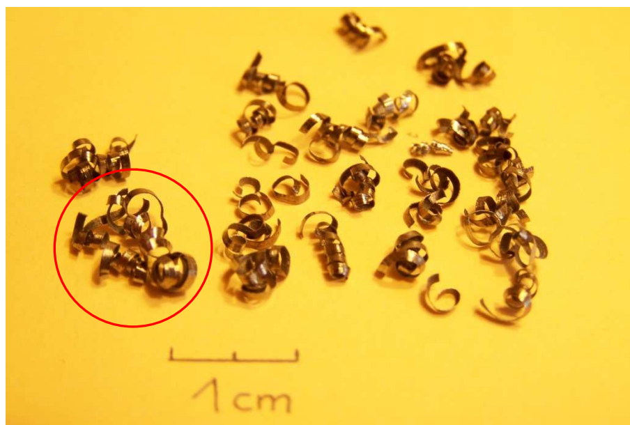
Rys. 7.24. Widok uzyskanych kształtów wiórów dla przypadku 1
