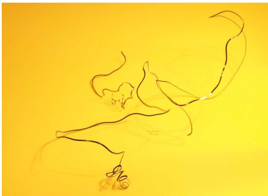
Rys. 7.30. Widok uzyskanych kształtów wiórów dla przypadku 4
