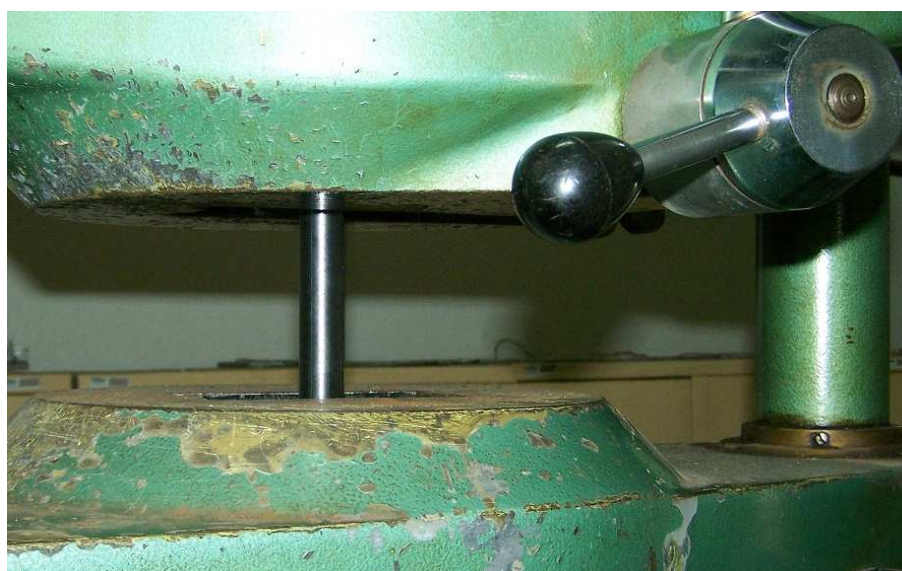
Rys. 5.9. Sposób mocowania próbki walcowej znormalizowanej do rozciągania w uchwytych maszyny wytrzymałościowej ZD 40
