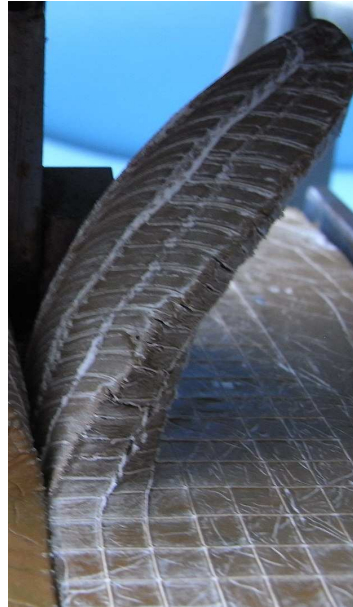
Rys. 3.26. Powstający wiór w trakcie doświadczenia dla a_p=9[\text{mm}] i \gamma=10^\circ
