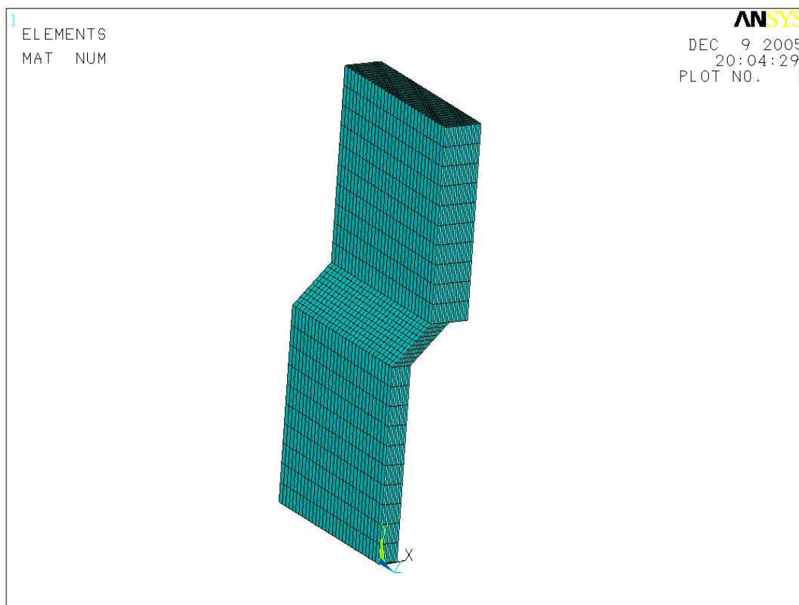
Rys. 6.51. Schemat diody cieplnej – model przyjęty do symulacji numerycznej
