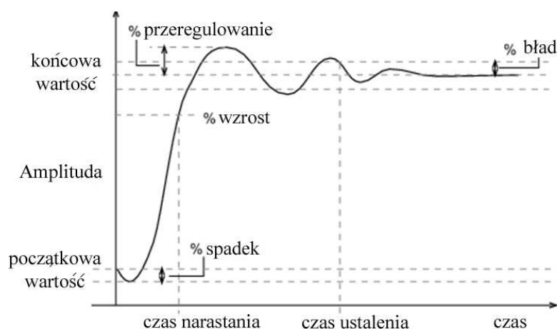
Rys. 76. Ograniczenia przy dobieraniu nastaw regulatora w celu określenia odpowiedzi układu na skokowe wymuszenie
