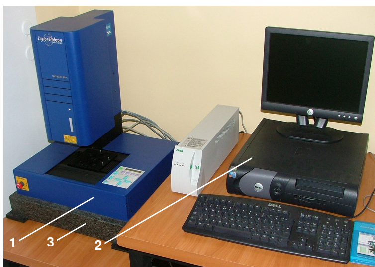
Rys. 5-26. Widok stanowiska do pomiaru topografii powierzchni narzędzi ściernych metodą bezstykową; 1 – profilometr TALYSCAN 150 z laserową głowicą pomiarową; 2 – komputer z oprogramowaniem; 3 – płyta granitowa
