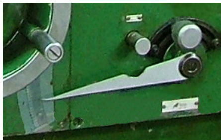
Rys. 5-18. Widok wskazówki oraz skali umożliwiających precyzyjne pozycjonowanie dźwigni zaworu regulującego prędkość posuwu osiowego stołu szlifierki RUP 28P
