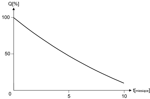
Rys. 2.19. Charakterystyka zmian pojemności akumulatora w czasie dla płyt antymonowo-ołowiowych [7]
