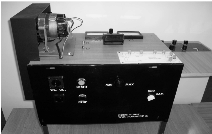
Rys. 5.14. Zdjęcie stanowiska laboratoryjnego do badania alternatora
