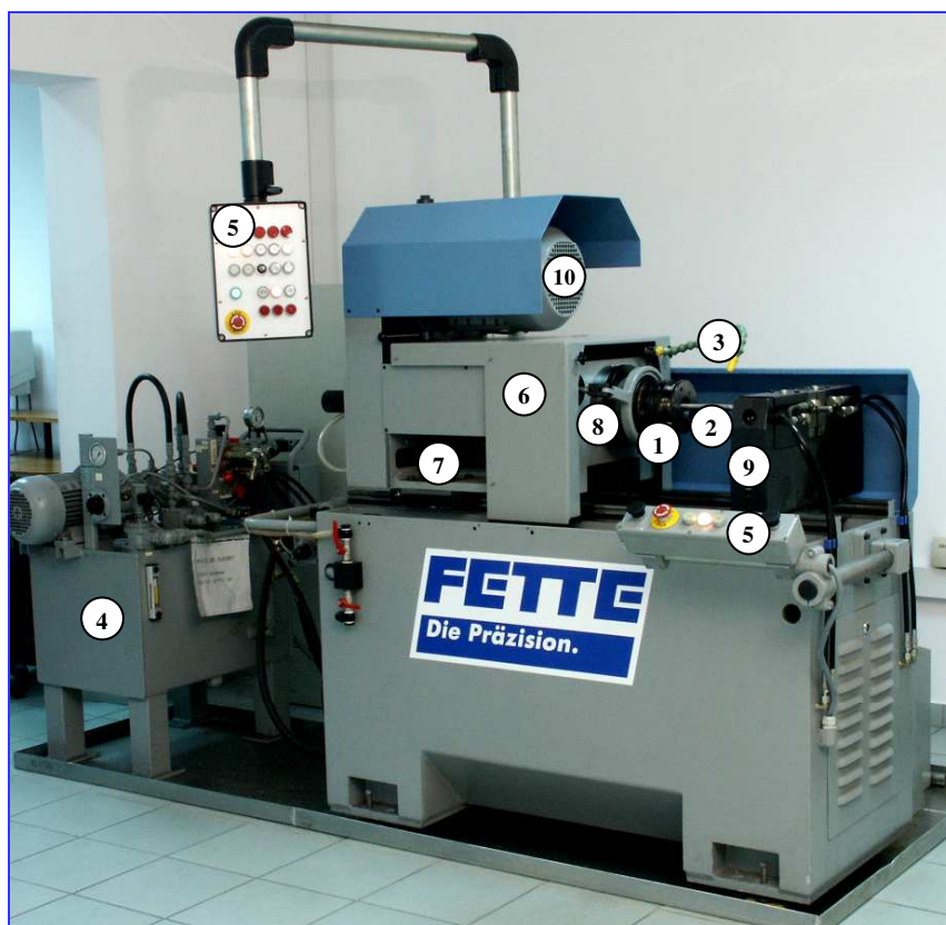
Rys. 2.10. Widok ogólny walcarki produkcji FETTE do walcowania gwintów metodą osiową: 1 - głowica, 2 - przedmiot, 3 - układ chłodząco-smarujący, 4 - zasilacz hydrauliczny, 5 - układ sterowniczy, 6 - wrzeciennik, 7 - układ sterujący przesunięciem wrzeciennika, 8 - układ do zamykania i otwierania głowicy, 9 - imak hydrauliczny, 10 - silnik walcarki
