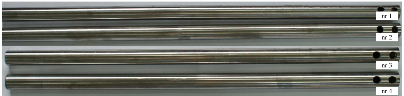
Rys. 8.3. Widok przykładowych próbek do walcowania gwintów o zarysie łukowym
