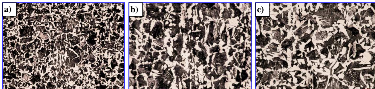
Rys. Z.8. Zdjęcia mikrostruktury stali C 45 (walcowanej) – przekrój wzdłużny powiększenie \times 80 (a), \times 150 (b), \times 200 (c),
