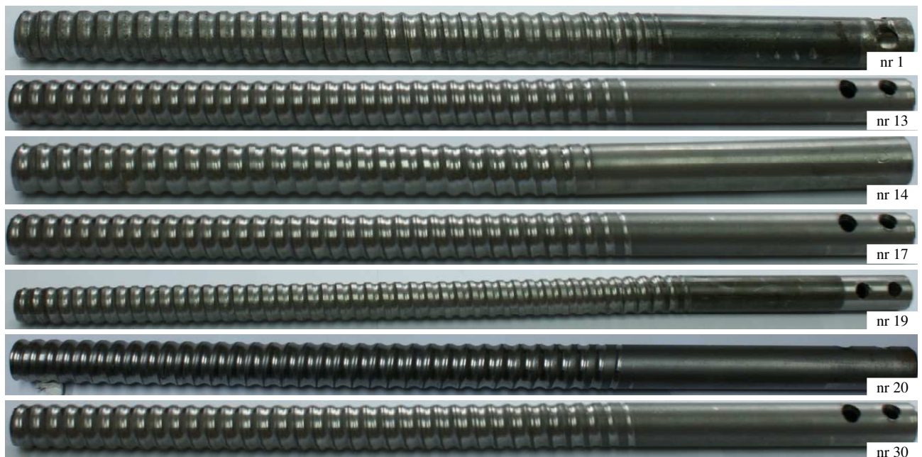
Rys. 8.8. Przykładowe próbki po walcowaniu gwintu \phi 31 \times 12,56
