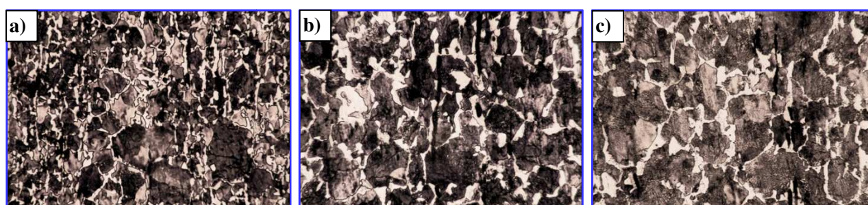
Rys. Z.6. Zdjęcia mikrostruktury stali C 45 (ciągnionej) – przekrój wzdłużny powiększenie \times 80 (a), \times 150 (b), \times 200 (c)
