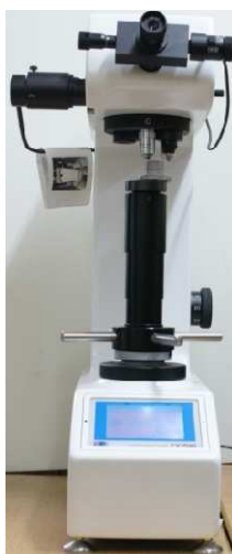
Rys. Z.1. Twardościomierz Vickersa – Vickers Hardnes Tester FV-700 firmy Future Tech
