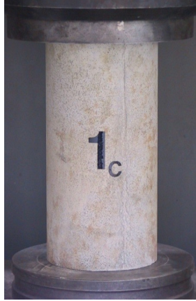
Rys. 5.2.3 Widok próbki walcowej w trakcie badania: a) wytrzymałości na ściskanie próbek „świadków”, b) modułu sprężystości
