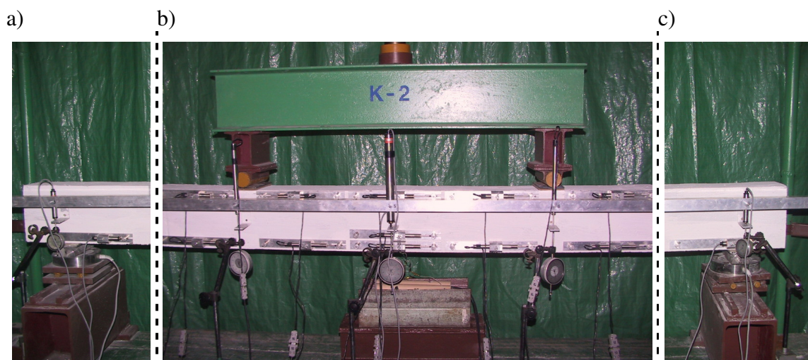
Rys. 7.2.1 Rozmieszczenie czujników do pomiaru przemieszczeń pionowych:
