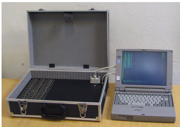
Rys. 5.3.3 Komputerowy system akwizycji danych SAD 256
