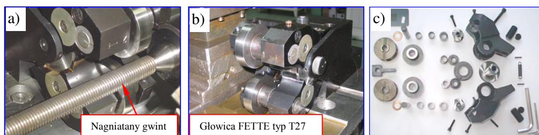
Rys. 2.32. Głowica FETTE typ T27 a) widok układu obróbkowego, b) widok głowicy, c) części składowe
