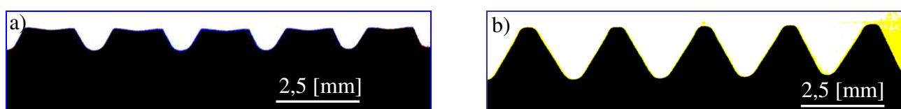
Rys. 2.20. Zdjęcia gwintu M22 \times 2,5 walcowanego na wałkach ze stali 45 ( v = 0,029 [m/s]): a) 45% zaawansowania procesu, b) 100% zaawansowania procesu
