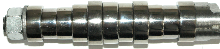
Rys. 111. Ustawienie zestawu próbek wykonanych z żeliwa EN GJL 150 podczas pomiar 3 w serii 3 Fig. 111. Settings of sample set made from cast iron EN GJL 150 during measurement 3 in series 3
