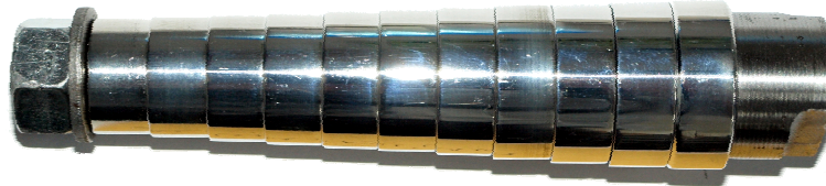
Rys. 93. Ustawienie zestawu próbek wykonanych z aluminium EN AW-6082 podczas pomiar 1 w serii 1 Fig. 93. Settings of sample set made from aluminium EN AW-6082 during measurement 1 in series 1
