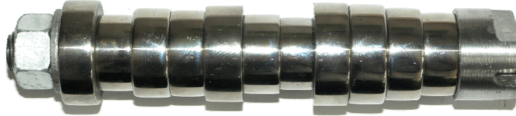
Rys. 113. Ustawienie zestawu próbek wykonanych z żeliwa EN GJL 150 podczas pomiar 4 w serii 3 Fig. 113. Settings of sample set made from cast iron EN GJL 150 during measurement 4 in series 3
