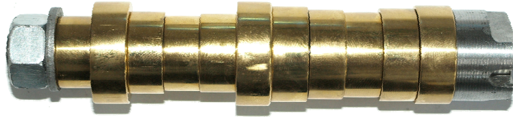
Rys. 107. Ustawienie zestawu próbek wykonanych z mosiądzu EN CW612N podczas pomiar 5 w serii 2 Fig. 107. Settings of sample set made made brass EN CW612N during measurement 5 in series 2
