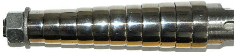
Rys. 108. Ustawienie zestawu próbek wykonanych z żeliwa EN GJL 150 podczas pomiar 1 w serii 3 Fig. 108. Settings of sample set made made from cast iron EN GJL 150 during measurement 1 in series 3
