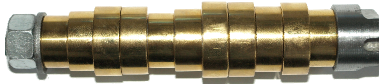
Rys. 105. Ustawienie zestawu próbek wykonanych z mosiądzu EN CW612N podczas pomiar 4 w serii 2 Fig. 105. Settings of sample set made made brass EN CW612N during measurement 4 in series 2
