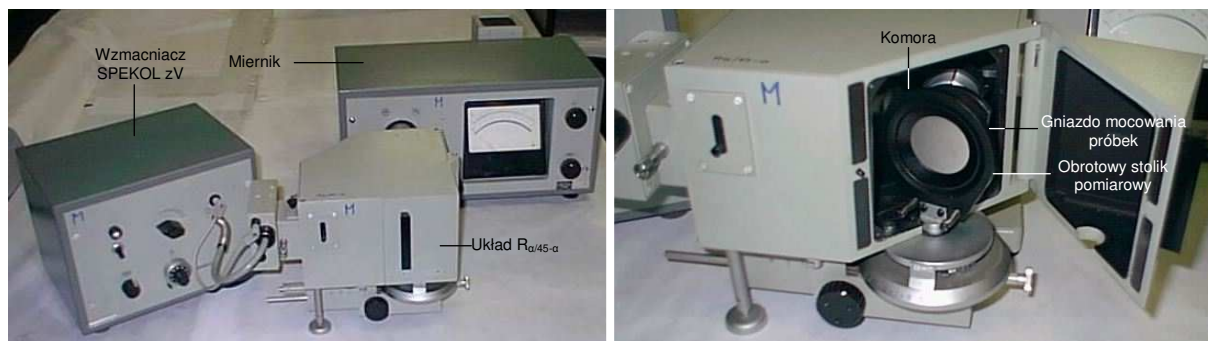
Rys. 19. Spektrofotometr SPEKOL z układem R_{\alpha/45-\alpha} przeznaczony do badań kąтового rozkładu natężenia światła rozproszonego Fig. 19. Spectrophotometer SPEKOL with R_{\alpha/45-\alpha} system applied for assessment of angular distribution of scattered light intensity
