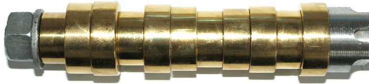
Rys. 104. Ustawienie zestawu próbek wykonanych z mosiądzu EN CW612N podczas pomiar 2 w serii 2 Fig. 104. Settings of sample set made from brass EN CW612N during measurement 2 in series 2
