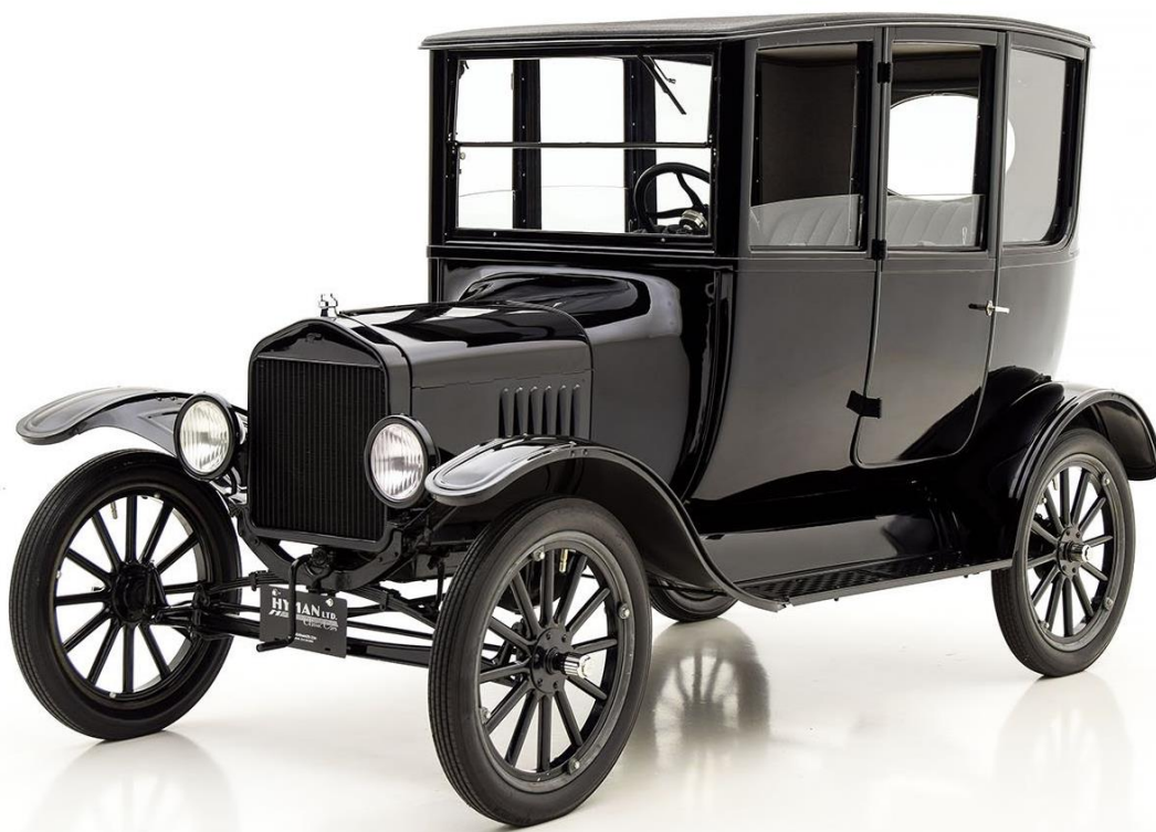
Rys. 2. Ford T z poprzecznym resorem [7]
