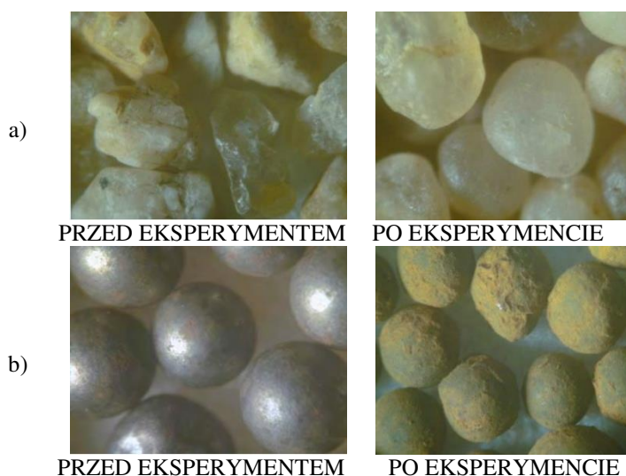
Rys. 2.18. Mikroskopowe porównanie ścierniwi (powiększenie \times 15 ): a) piasku kwarcowego, b) kulek stalowych, przed i po eksperymencie [46, 111]
