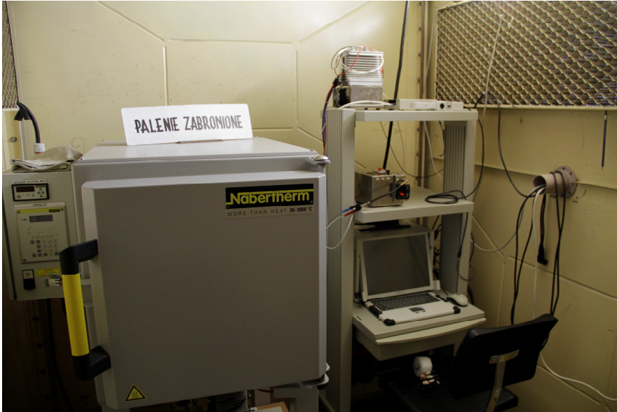
Stanowisko do badań termicznych elementów półprzewodnikowych
