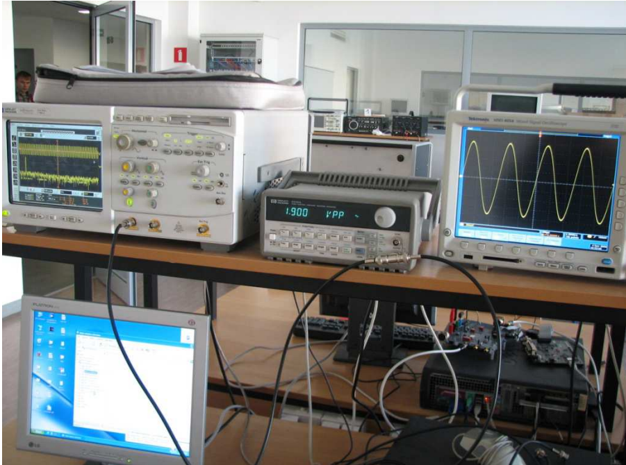
Stanowisko do badania przetworników C/A i A/C wyposażone w analizator sygnałów audio ATS-100
