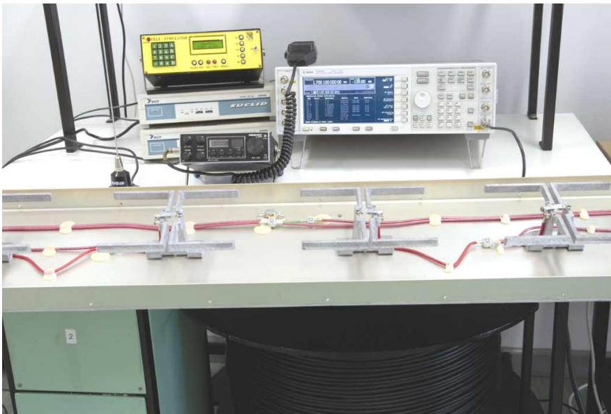
Stanowisko do badania anten
