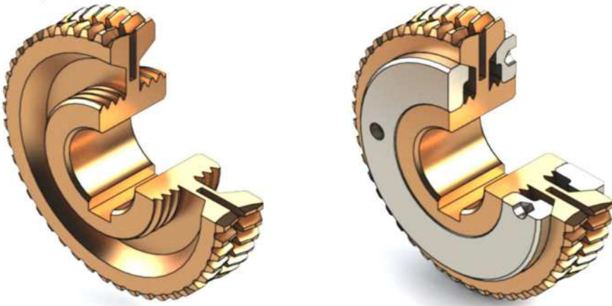
Rys. 18. Ślimacznica z wieńcem rozdzielonym obwodową szczeliną
