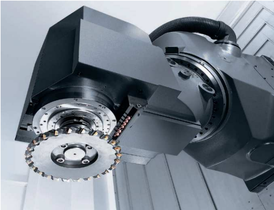
Rys. 3. Centrum obróbkowe do pięciostronnej obróbki DMG MORI Journal 1/2014, głowica narzędziowa duoBLOCK DMG MORI
