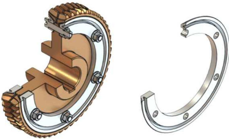
Rys. 19. Ślimacznica z elementem dociskającym posiadającym wgłębienie obwodowe
