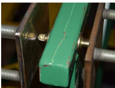
Rys. 5.13. Szczegóły techniczne stanowiska badawczego – podparcie poprzeczne w skrajnym węźle pasa górnego (nieprzesuwne w kierunku poprzecznym)
