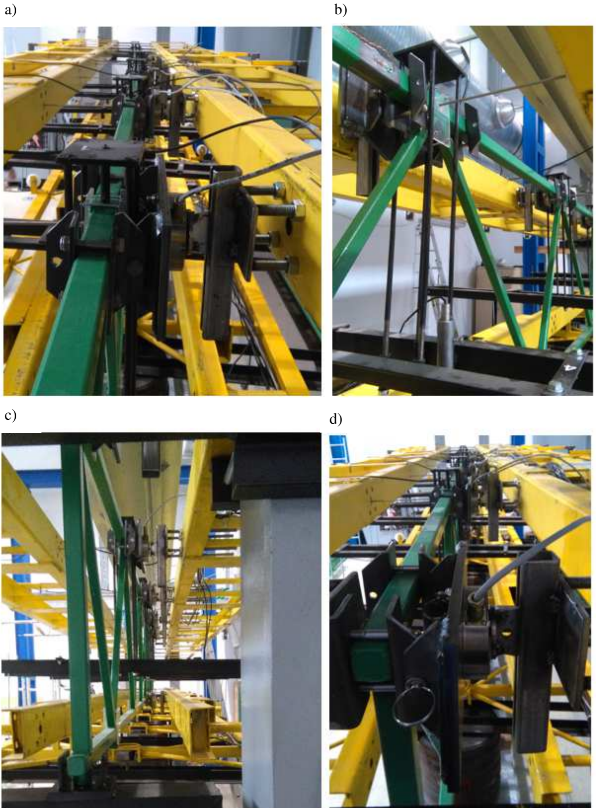
Rys. 5.25. Zdjęcia z badań doświadczalnych: a) Model 1 – widok pasa górnego, b) Model 4 – widok czujników przemieszczeń (ugięcie kratownicy i podatność podpory na przesuw), c) Model 6 – widok pasów kratownicy, d) Model 8 – widok podpory skrajnej na węźle 0
