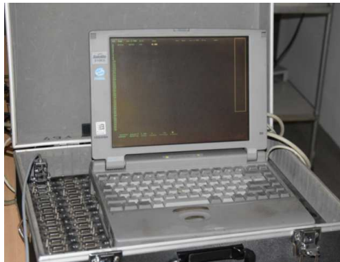
Rys. 5.23. System akwizycji danych SAD 256
