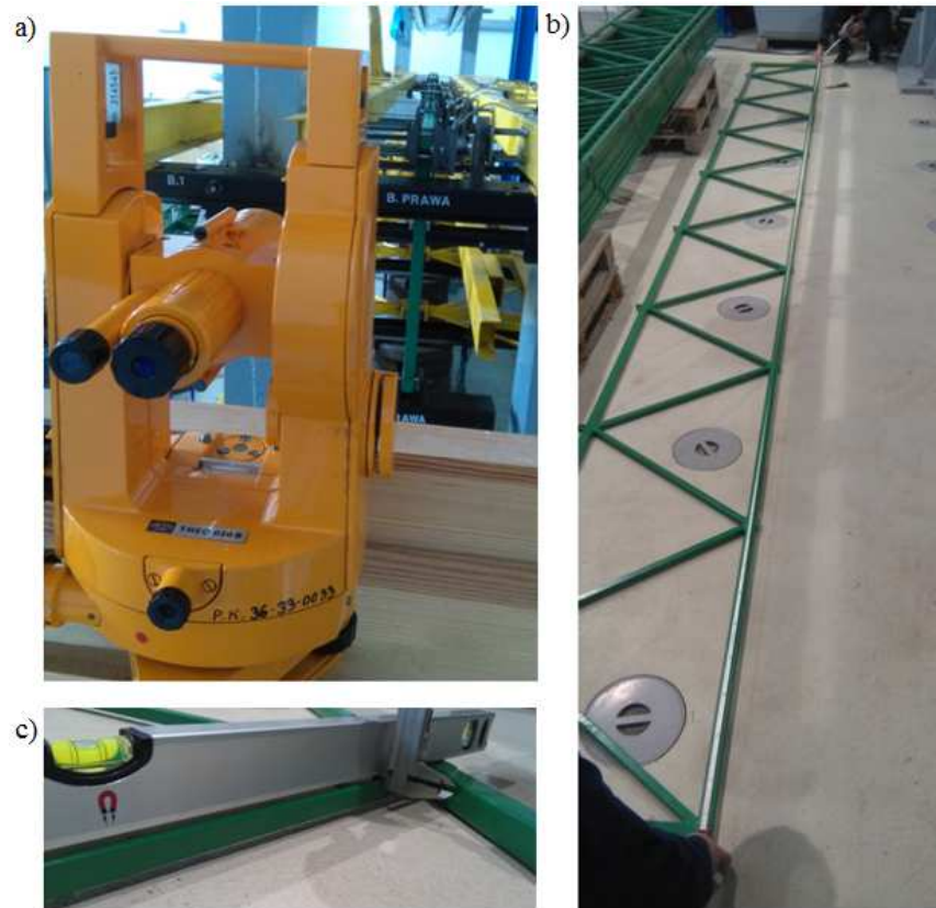
Rys. 5.4. Pomiar wstępnych imperfekcji modeli badawczych: a) pomiar prostoliniowości pasów „z płaszczyzny”, b) pomiar długości kratownicy i przedziałów skratowania, c) pomiar wygięcia krzyżulców z płaszczyzny kratownicy
