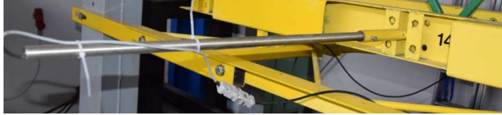
Rys. 5.16. Szczegóły techniczne stanowiska badawczego – czujnik przemieszczeń liniowych
