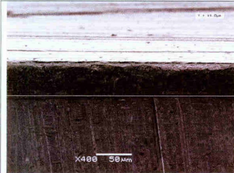
Powłoka \text{Cr}_2\text{N}/\text{CrN} , N_{\Lambda} = 7 , (1:1) stępienie ostrza VB_{\alpha} \sim 44\mu\text{m}
