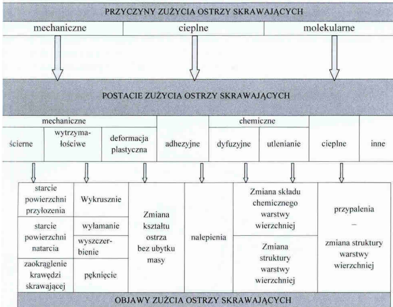
Rys.9. Przyczyny, postacie i objawy zużycia ostrzy skrawających [39].
