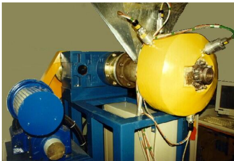
Rys. 5.4. Układ uplastyczniający z zespołem napędowym; silnik napędowy, reduktor i układ sterujący
