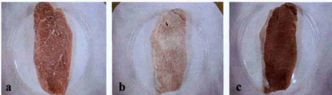
Rys. 8.25. Fotografie przedstawiające próbkę mięsa w kolejnych etapach rozmrażania sublimacyjno-próżniowo-parowego: a - próbka zamrożona, b - próbka po okresie sublimacji, c - próbka rozmrożona.
