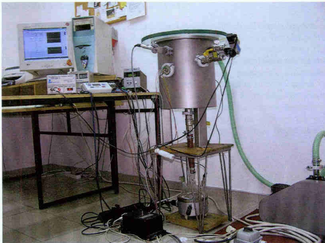
Rys. 6.6. Komora próżniowa i komputerowy układ pomiarowo - rejestrujący
