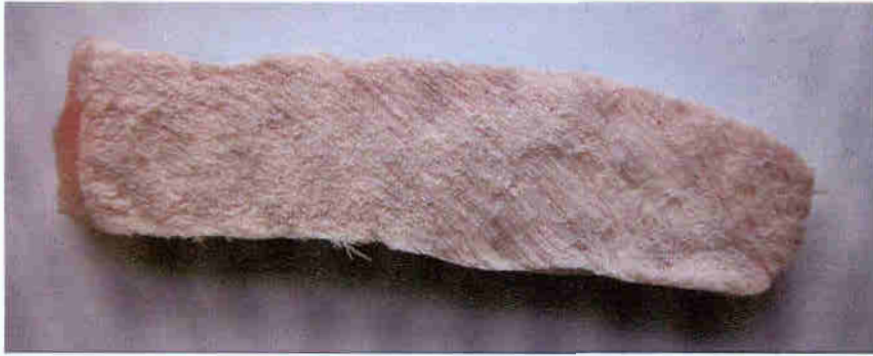
Rys. 8.17. Przekrój poprzeczny całkowicie odwodnionej próbki mięsa podczas sublimacji bez dostarczania ciepła
