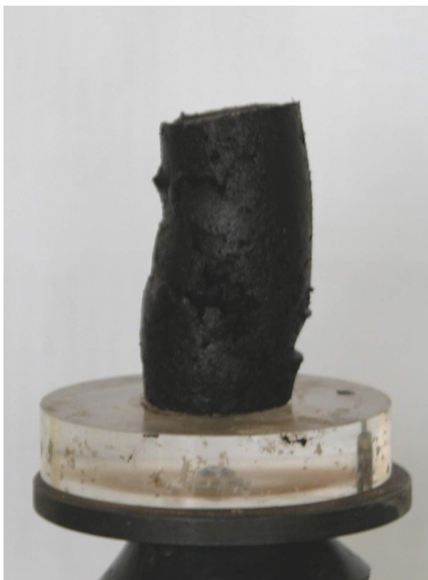
Rys. 5.13 Ścięcie „płynięcie” torfu stabilizowanego C/P 50/50/250.
