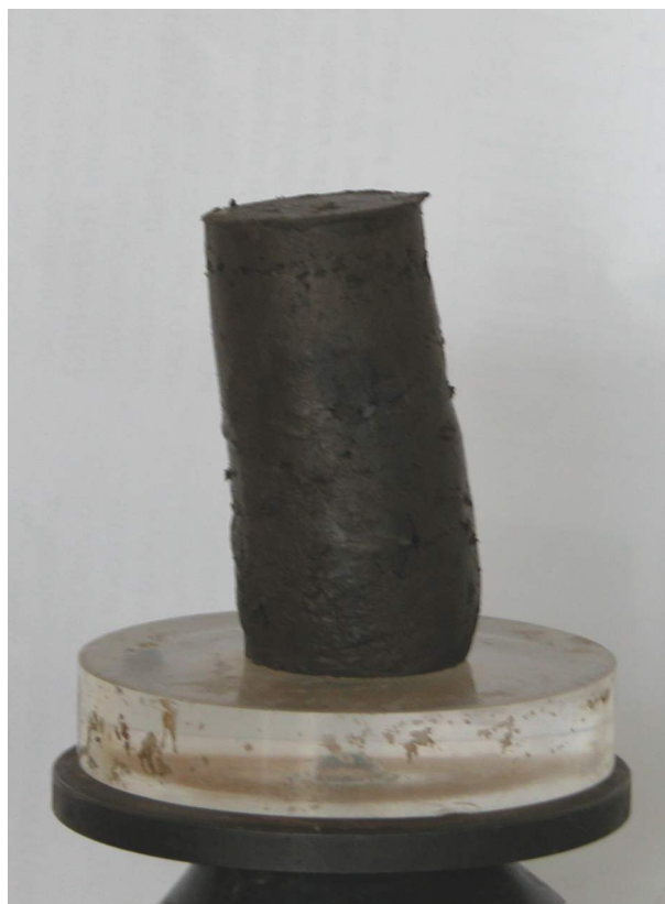
Rys. 5.14 Ścięcie „płynięcie” namułu stabilizowanego C/P 25/75/150.
