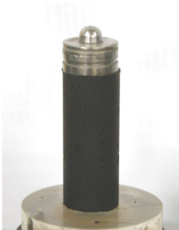
Rys. 5.16 Zdjęcie stabilizowanego torfu przed ścięciem C/P 100/0/250.
