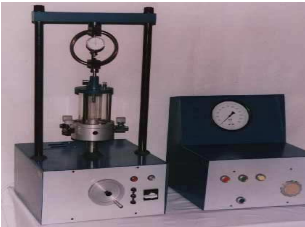
Rys. 4.5 Fotografia Aparatu Trójosiowego Ściskania Typu AT - 2, na którym były prowadzone badania na jednoosiowe ściskanie.
