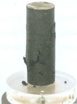
Rys. 5.21 Ścięcie „plastyczne” namułu stabilizowanego C/P 50/50/250.
