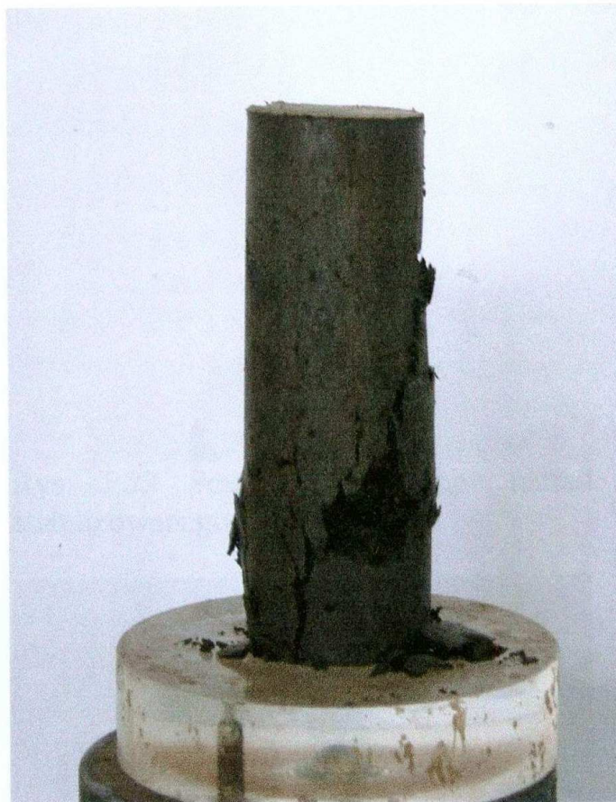
Rys. 5.18 Ścięcie „kruche” namułu stabilizowanego C/P 75/25/250.
