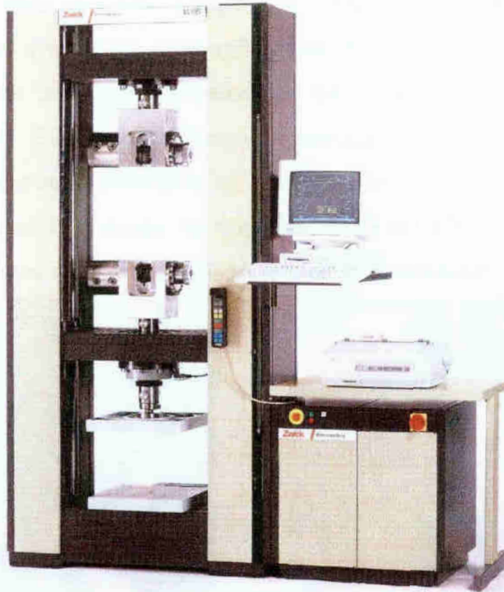
Rys. 2.1. Maszyna wytrzymałościowa Zwick 147670
