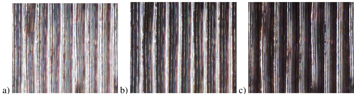
Rys. 26. Cyfrowy obraz powierzchni obrobionej dla posuwu 0,21mm, prędkości 187,5 m/min i czasu skrawania 6 min dla różnych sposobów oświetlenia a) oświetlenie dwustronne b) oświetlenie przeciwne do kierunku posuwu c) oświetlenie zgodne z kierunkiem posuwu
