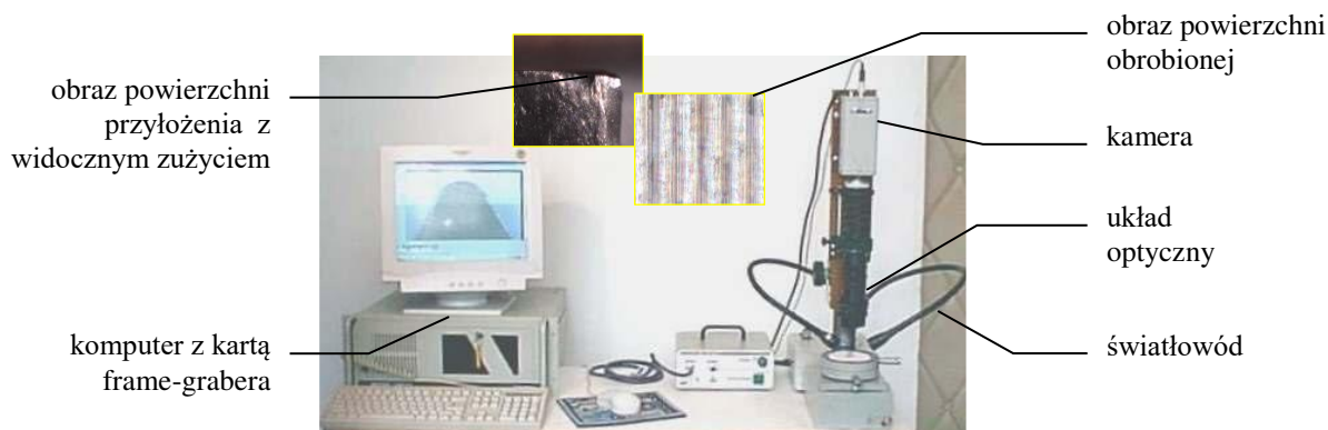
Rys. 48. Stanowisko do akwizycji obrazów [STO99-1]
