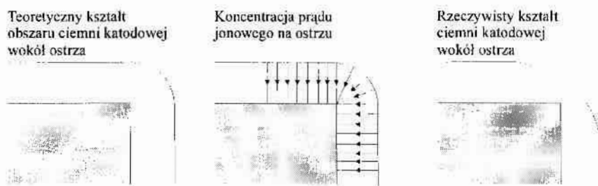
Rys.47. Zniekształcenie obszaru ciemni katodowej wokół ostrza [Joha84]
