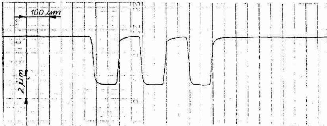
ys. 50. Wyniki otrzymane podczas sprawdzania błędu względnego powiększenia pionowego V_v = 5000\times profilometru ME10; a) wyniki uzyskane za pomocą stanowiska badawczego, b) profilogram drgań mechanicznych, c) profilogram wzorca kontrolnego, którego H_w = 4,25 \mu\text{m}
