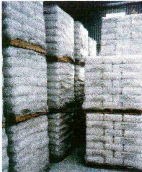
Rys.3.3.1.6. Mikrokrzemionka zapakowana w 20-kilogramowe papierowe worki ułożone na paletach przygotowanych do transportu.[202]
