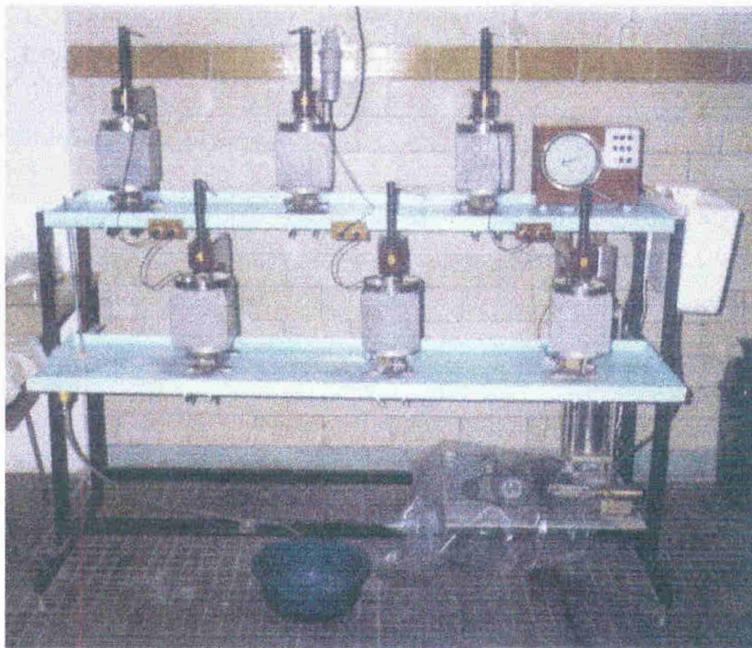
Rys.4.4.11.1. Urządzenie do badania przepuszczalności wody przez beton skonstruowane w ITB.
