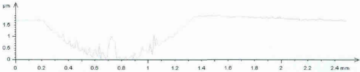
Rys. 116. Profil 2D śladu wytarcia próbki tinm33
