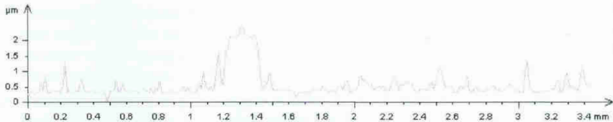
Rys.114. Narosty na próbce tina13, będące efektem katastroficznego zużycia przeciwpróbki
