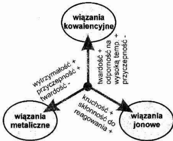
Rys.9. Trójkąt wiązań przedstawiający wpływ typu wiązania na właściwości twardych materiałów powłokowych [Holl91]
