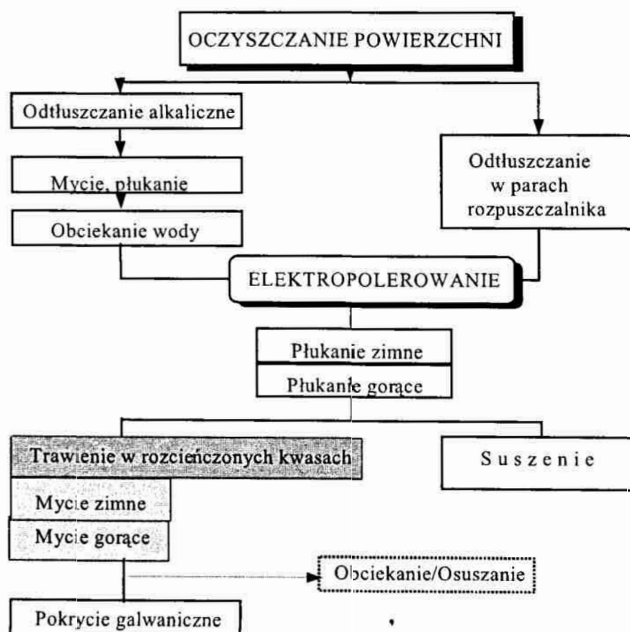
Rys. 5.13. Schemat procesu technologicznego polerowania elektrolitycznego
