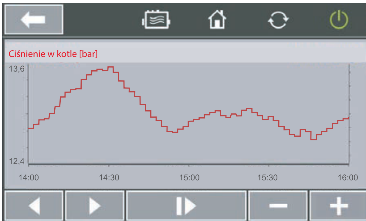
Ryc. 5 Przebieg ciśnienia w czasie (sterowanie kotłem BCO)
