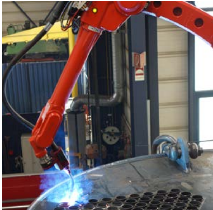
Ryc. 132 Mobilny robot spawający w produkcji kotłów przemysłowych Bosch
