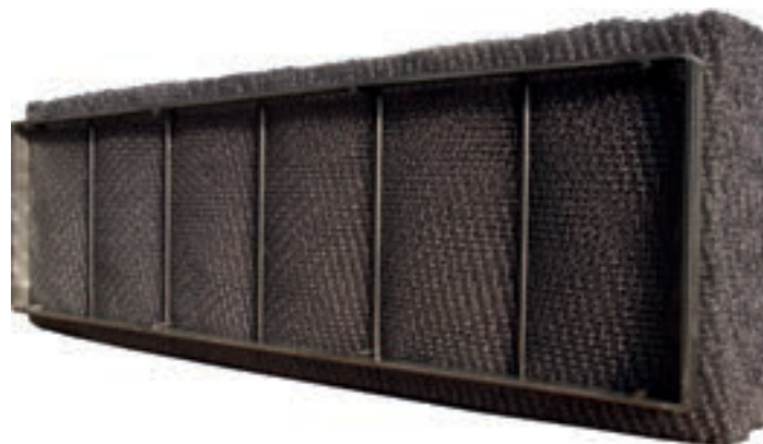
Ryc. 103 Separator siatkowy - w takiej postaci jest umieszczany w kotłach parowych bezpośrednio pod króćcem wylotu pary
