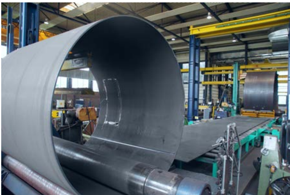
Ryc. 133 Nasza technologia umożliwia gięcie blach o szerokości do 3,5 m
