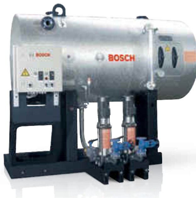
Ryc. 201 Bezciśnieniowy moduł gromadzenia kondensatu zbiera spływający kondensat i zwraca go (via system odgazowywacza) do obiegu wodno-parowego
