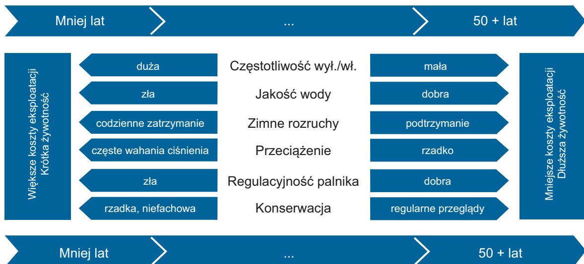
Ryc. 22 Wpływ sposobu eksploatacji kotła na jego żywotność
