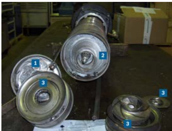
Ryc. 26 Uszkodzenia pomp przez kawitację
