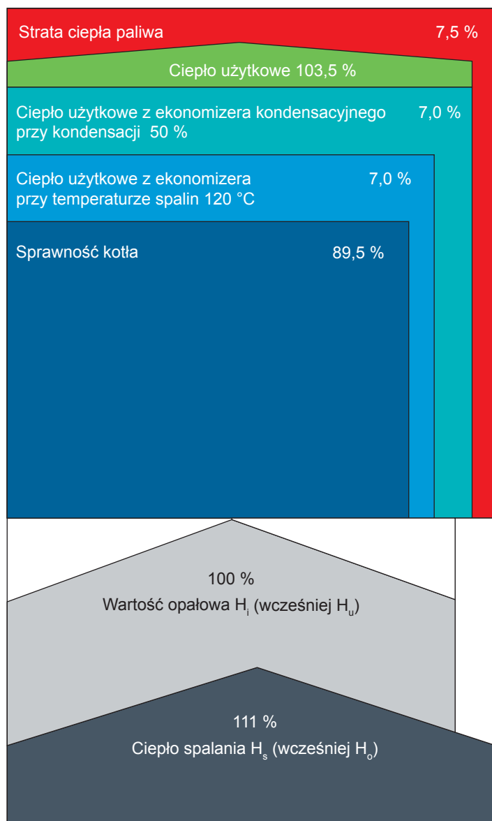
Ryc. 134 Bilans cieplny wytwornicy pary z wykorzystaniem techniki kondensacyjnej i paliwem opalanym gazem (wartości przykładowe)
