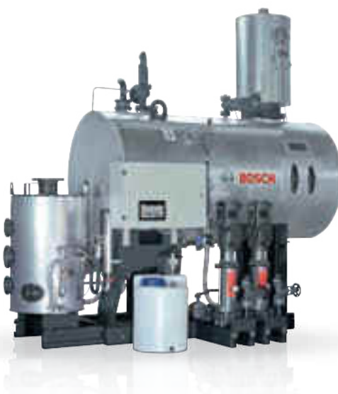
Ryc. 97 Moduł przygotowania wody, składający się ze zbiornika wody zasilającej z odgazowywaczem ociekowym, modułów pomp zasilających, zbiornika rozprężnego odmulin i odsolin, modułu dozowania chemicznych środków korygujących i szafy sterowniczej
