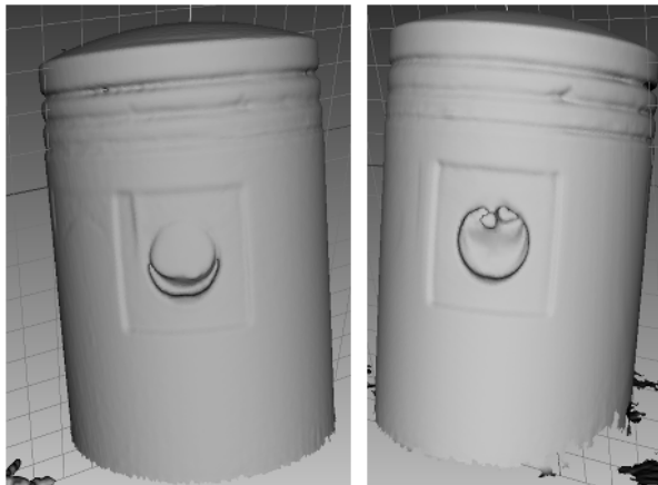
Rys. 7. Jakość modeli tła bez nałożonej tekstury: z lewej – rezultat skanowania skanerem Spider, z prawej – rezultat skanowania skanerem Eva [opracowanie własne]
