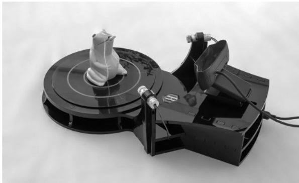
Rys. 2. Skanowanie 3D metodą bezdotykową [5]
