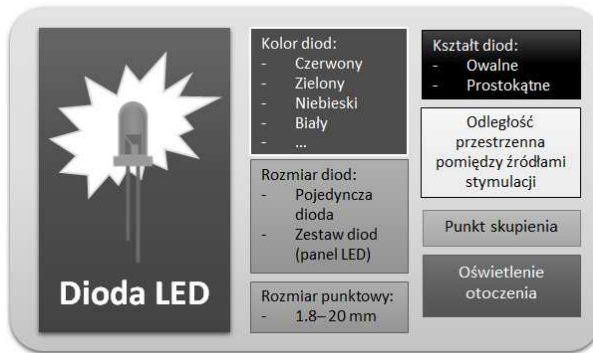
Rys. 4. Parametry urządzeń stymulujących opartych na diodach LED
