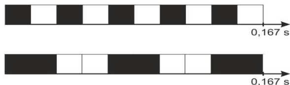
Rys. 3. Sposób wyświetlania klatek obrazu: na górze dzielnik 1 (zmiana stanu co 1 klatkę), na dole dzielnik 2 (zmiana stanu co 2 klatki)
