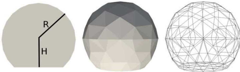
Rys. 1. Badana komórka pamięci. R=2 nm, H=1.5 nm, materiał Fe
